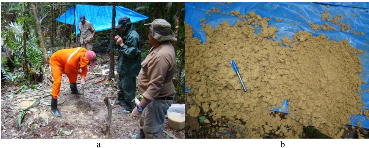
Figura 7 - Furo IT-02: a) perfuração em área de floresta primária (**Área 1**); b) amostra do intervalo 1,5 a 2,5m, correspondente a solo argilo-arenoso.
