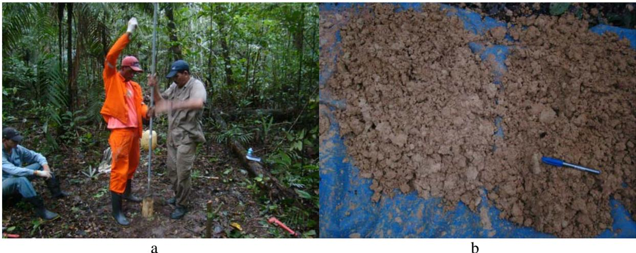
Figura 11 – Furo IT-06: a) perfuração em área de floresta primária (**Área 1**); b) amostra do intervalo 1,5 a 2,5m, correspondente a solo argiloso com pouca areia fina.
