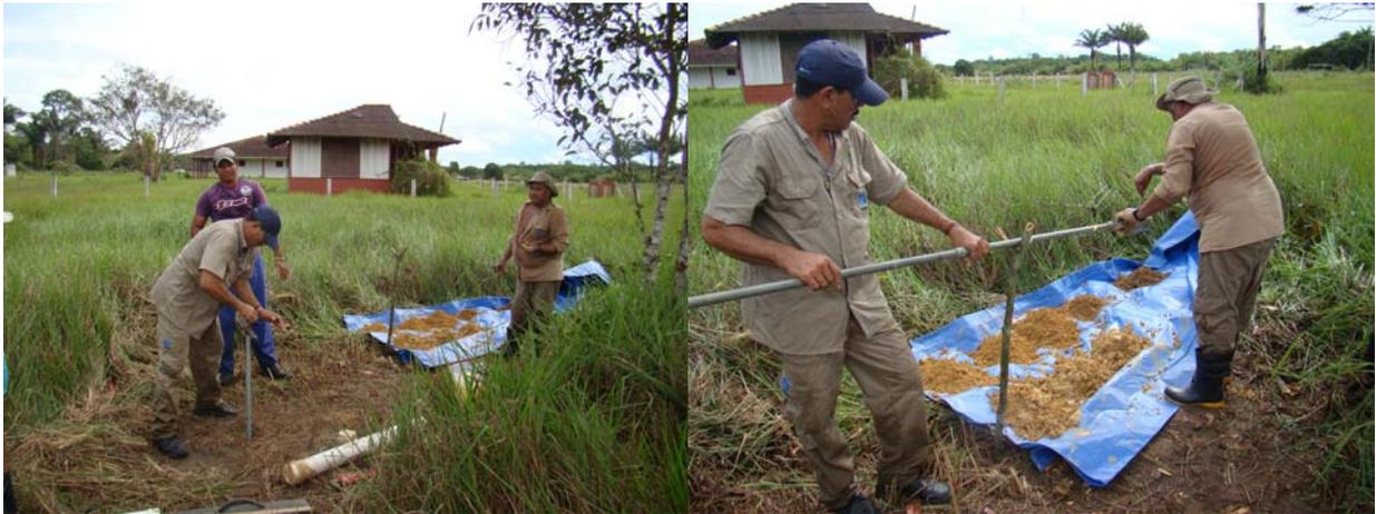
Figura 6 - Aspectos da perfuração e do material retirado do furo IT-01 na **Área 2**.
