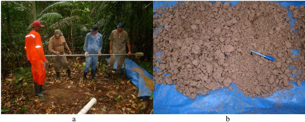
Figura 10 – Furo IT-05: a) retirada de material perfurado, para descrição e amostragem; b) amostra do intervalo 1,0 a 2,0m, correspondente a solo arenoso alaranjado.
