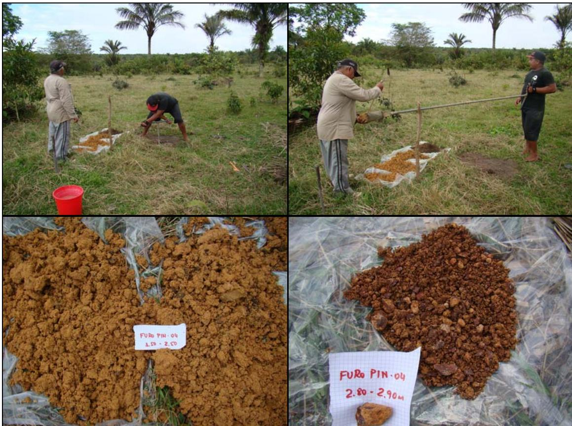
Figura 12: Aspectos da perfuração e do material atravessado em dois intervalos do furo PIN-04.
