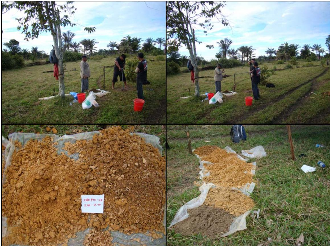
Figura 14: Aspectos da perfuração e do material atravessado pelo furo PIN-06.
