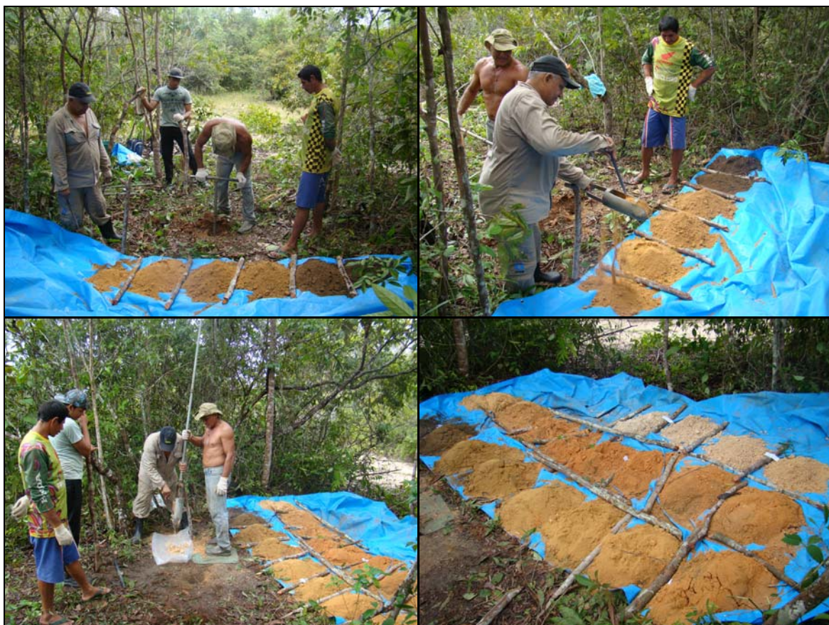
Figura 8: Aspectos da perfuração e de todo material atravessado pelo furo VA-03.
