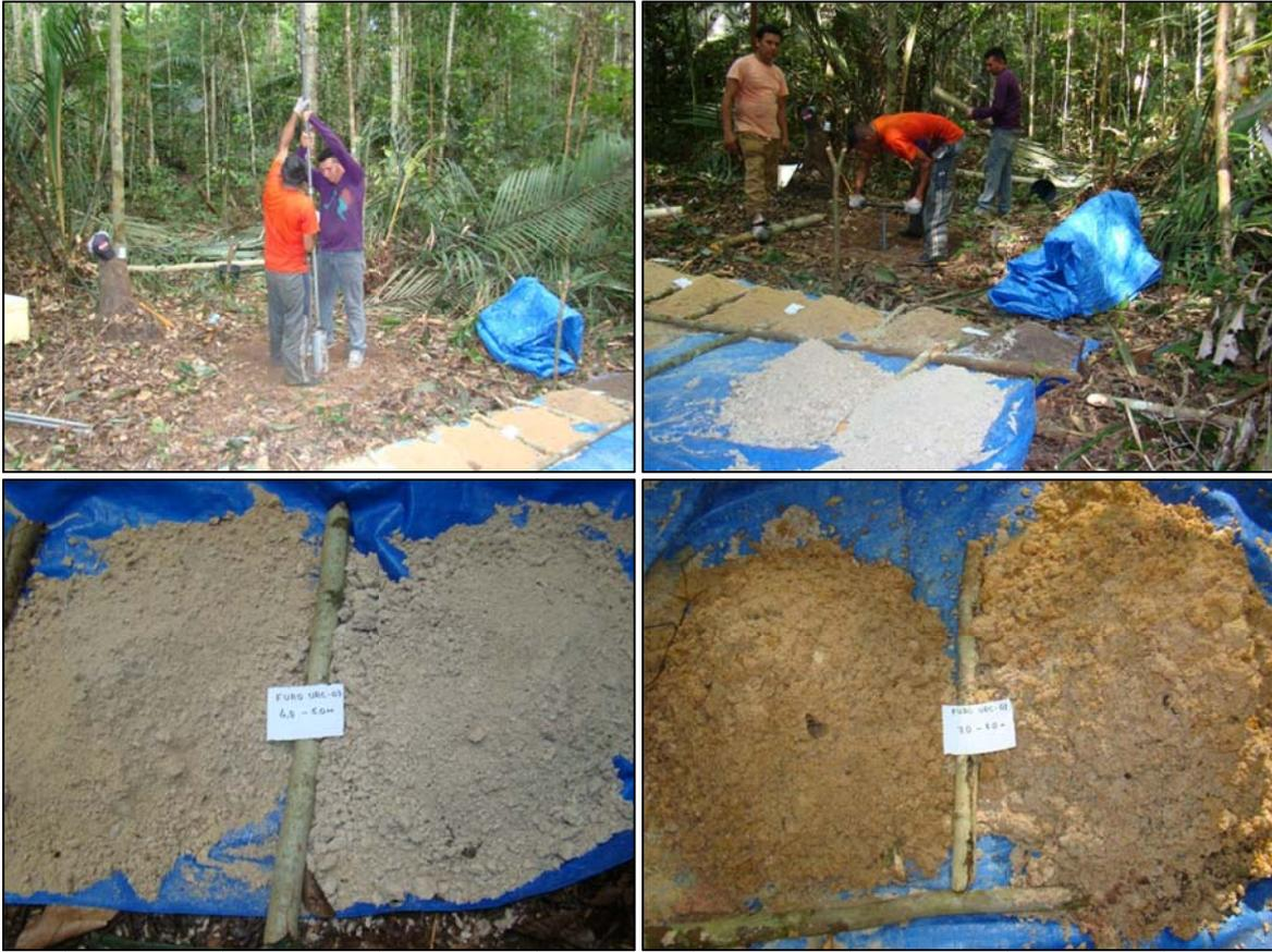
**Figura 9:** Aspectos da perfuração e do material atravessado em dois intervalos do furo URC-03.
