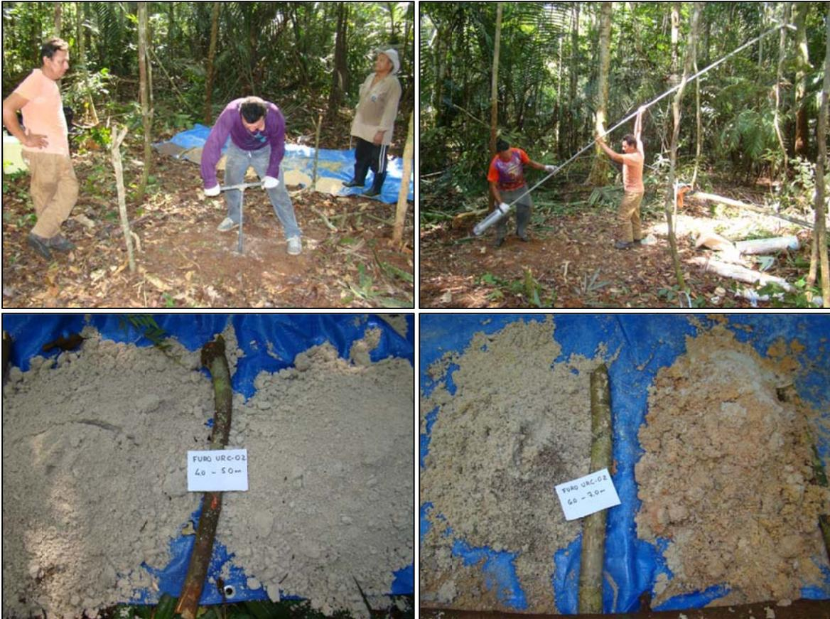
**Figura 8:** Aspectos da perfuração e do material atravessado em dois intervalos do furo URC-02.
