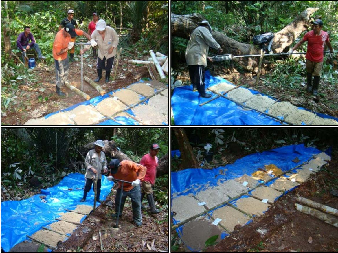
**Figura 7:** Aspectos da perfuração e de todo material atravessado pelo furo URC-01.
