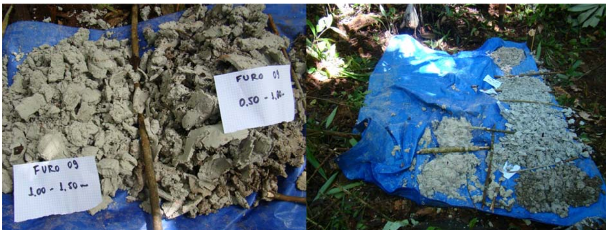
Figura 13 – Furo 09: Silte-argiloso, de consistência plástica, cinza-claro, conhecido como “Tabatinga” (esquerda), e visão de todo o material testemunhado nessa perfuração (direita).
