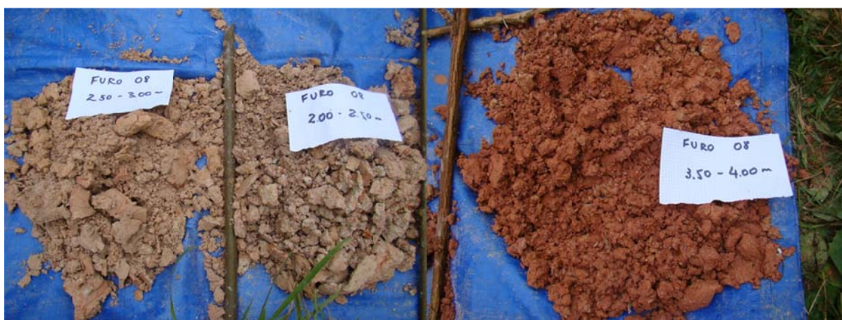
Figura 11 – Horizonte mosqueado siltoso/argiloso (esquerda) e camada areno-siltosa (direita) perfurados no furo 08.
