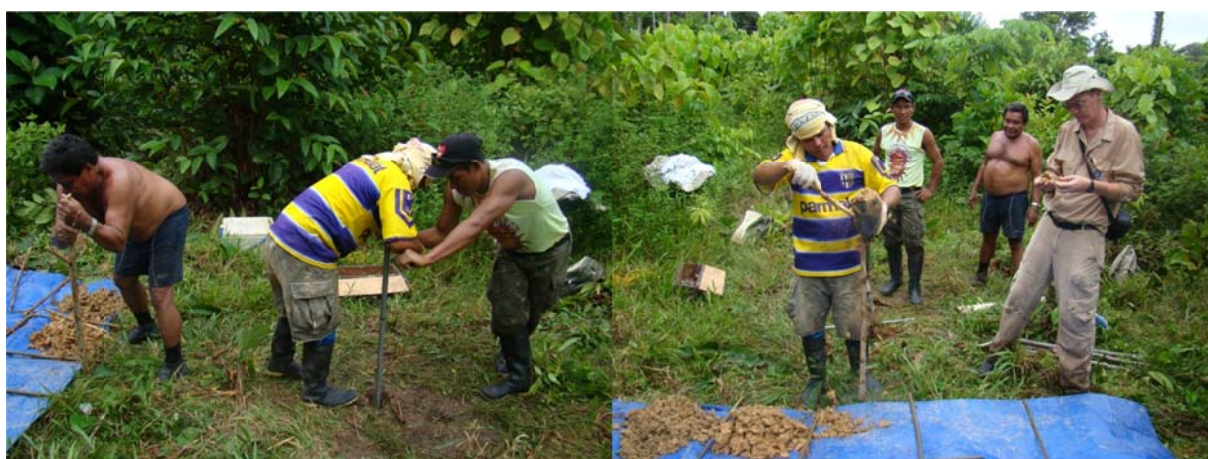
Figura 10 - Aspectos da perfuração e do material retirado do furo 08, em área desmatada.
