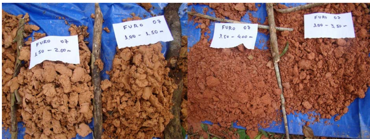
Figura 9 – Solo argiloso/siltoso (esquerda) e camada areno-siltosa (direita) perfurados no furo 07.
