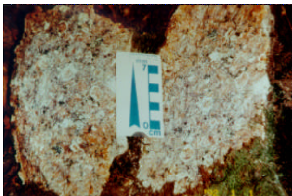
Figura 2.15 – Fotografia de biotita microssienogranito porfirítico granofírico, inequigranular fino com fenocristais médios a grossos de ortoclásio manteados por albita (textura rapakivi), encontrado no rio Parauari (afloreamento MA-55).
