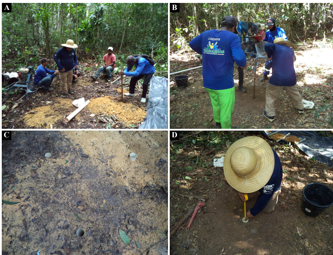
Figura 11 - (A) e (B) Início das perfurações para a realização dos ensaios de infiltração nos pontos PGM-01 e PGM-02; (C) e (D) Posição dos três furos feitos para o ensaio e medição do rebaixamento do nível da água no PGM-02.
