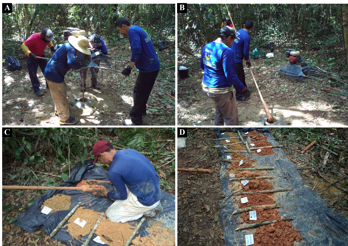
Figura 13 - Aspectos da perfuração, da retirada de amostras e de todo o perfil de solo/subsolo atravessado pelo furo PGM-02.
