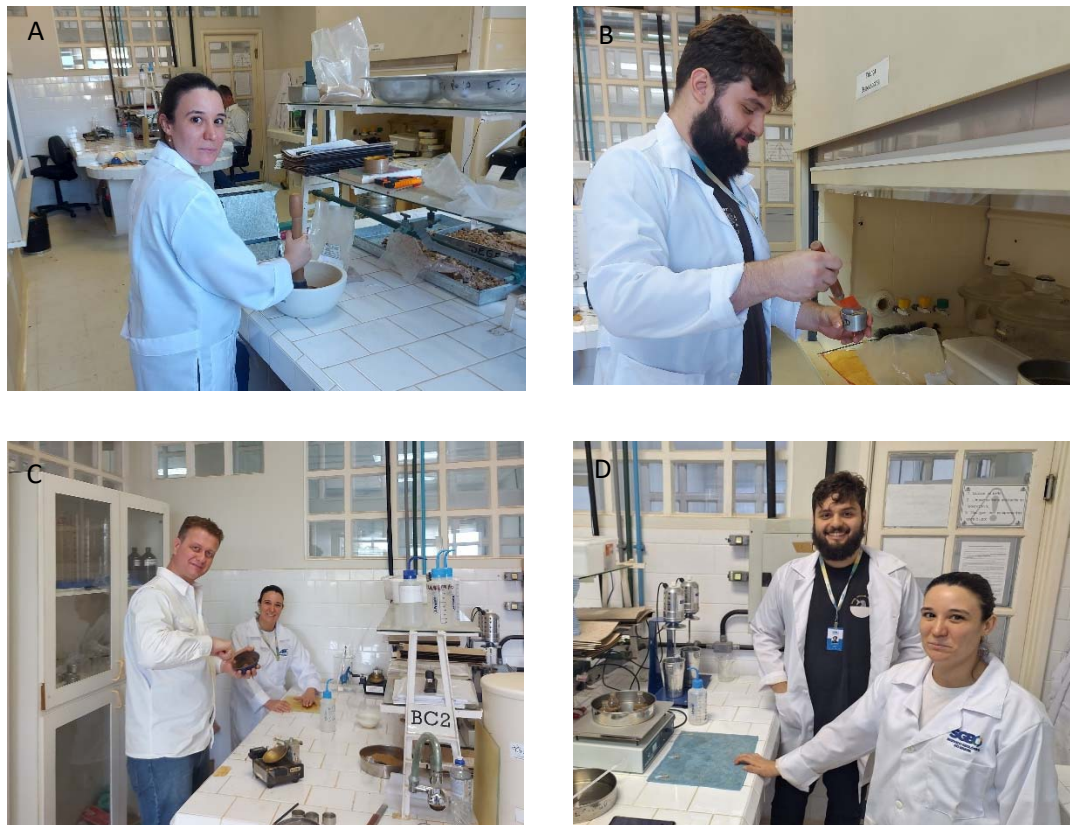
Figura 5 - Procedimentos e ensaios realizados: (A) Preparação de amostra, (B) Umidade Higroscópica, (C) Limite de Líquides e de Plasticidade e (D) Densidade real dos grãos.
