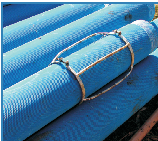
Figura 13. Revestimento tipo geomecânico PVC, com centralizador.
