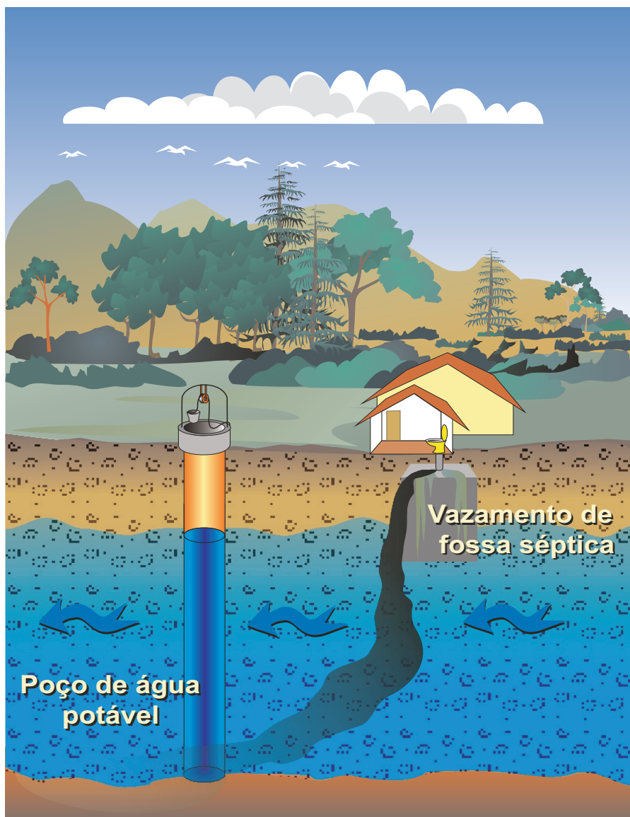
Figura 25. Tipo de contaminação de poço por fossa (fonte: Teixeira, 2006).
