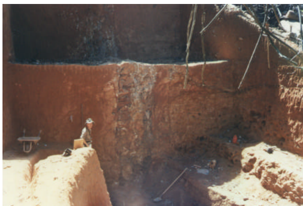
Figura 4.8 – Veio de quartzo aurífero no garimpo do Palito (veio simples).
