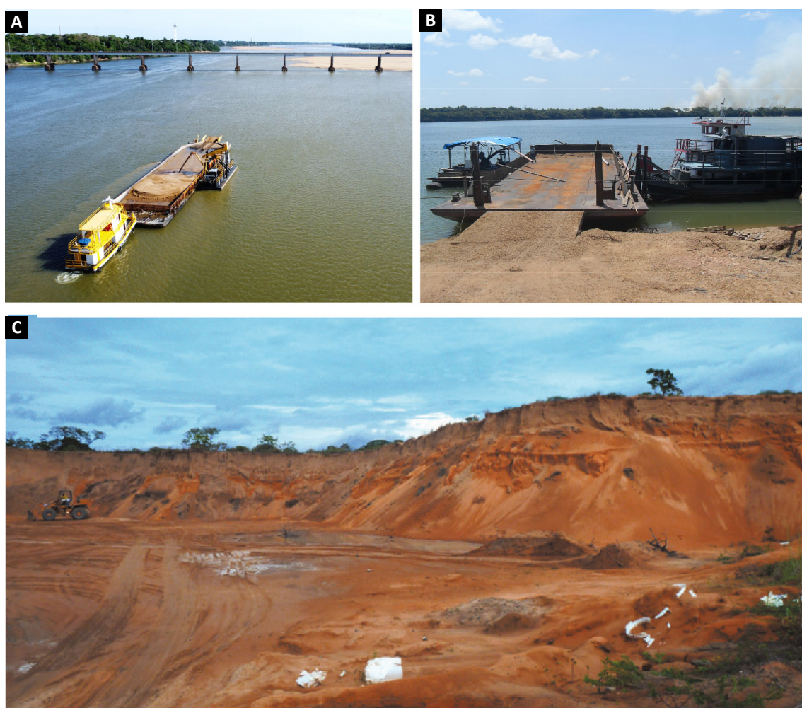
Figura 5.15 - A) Extração de sedimentos aluvionares do Rio Branco via balsa e draga de sucção, próximo à ponte dos Macuxis em Boa Vista; B) Balsa e draga de sucção no porto da CERR, em Caracará (Silva, 2011); C) Extração de areia no campo de dunas da Fazenda Santa Clara (Holanda; Marmos; Maia, 2014).
