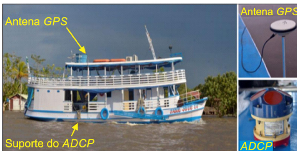
Figura 31 – Embarcação utilizada para medição de vazão em grandes rios.
