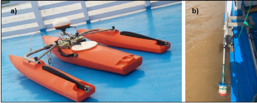
Figura 20 – Exemplos de arranjos de montagem do RiverRay (a) o RiverRay montado no Trimarã e (b) RiverRay montado em um suporte de alumínio
