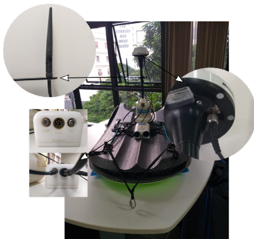
Figura 47 – PCM Rover montado indicando detalhes de conexão dos cabos
