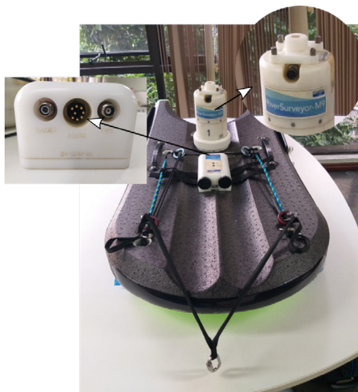
Figura 46 – ADP M9 e PCM Rover acoplados à Hydroboard II , detalhe indicando o posicionamento dos plugs que recebem o cabo de comunicação M9 – PCM Rover (item S-05)
