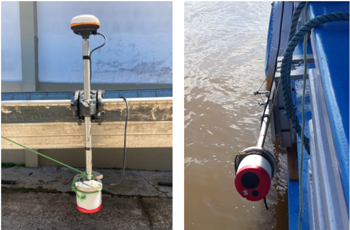
Figura 27 – Suporte adaptado instalado na lateral da embarcação
