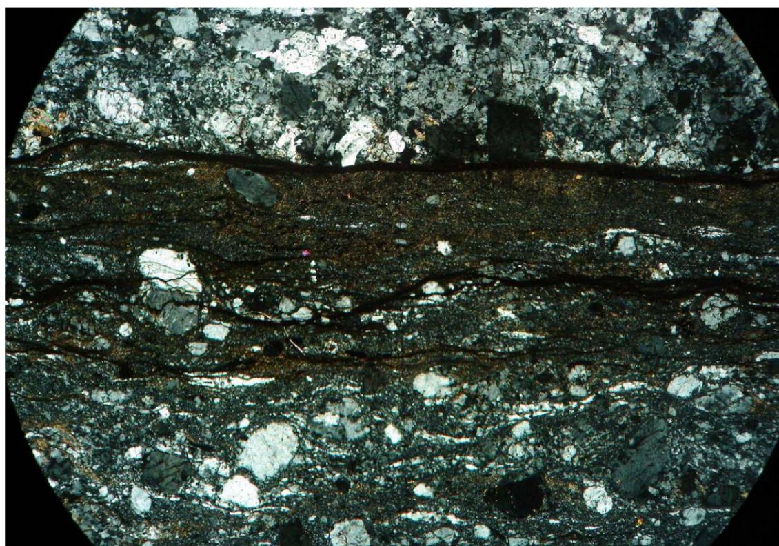
**Fotomicrografia 4.2d:** banda ultramilonítica  $D_2$  em rocha da unidade Candelária, com porfiroclastos de Kfs e fitas de Qtz (visada de 2,5x, lâmina FSR117)
