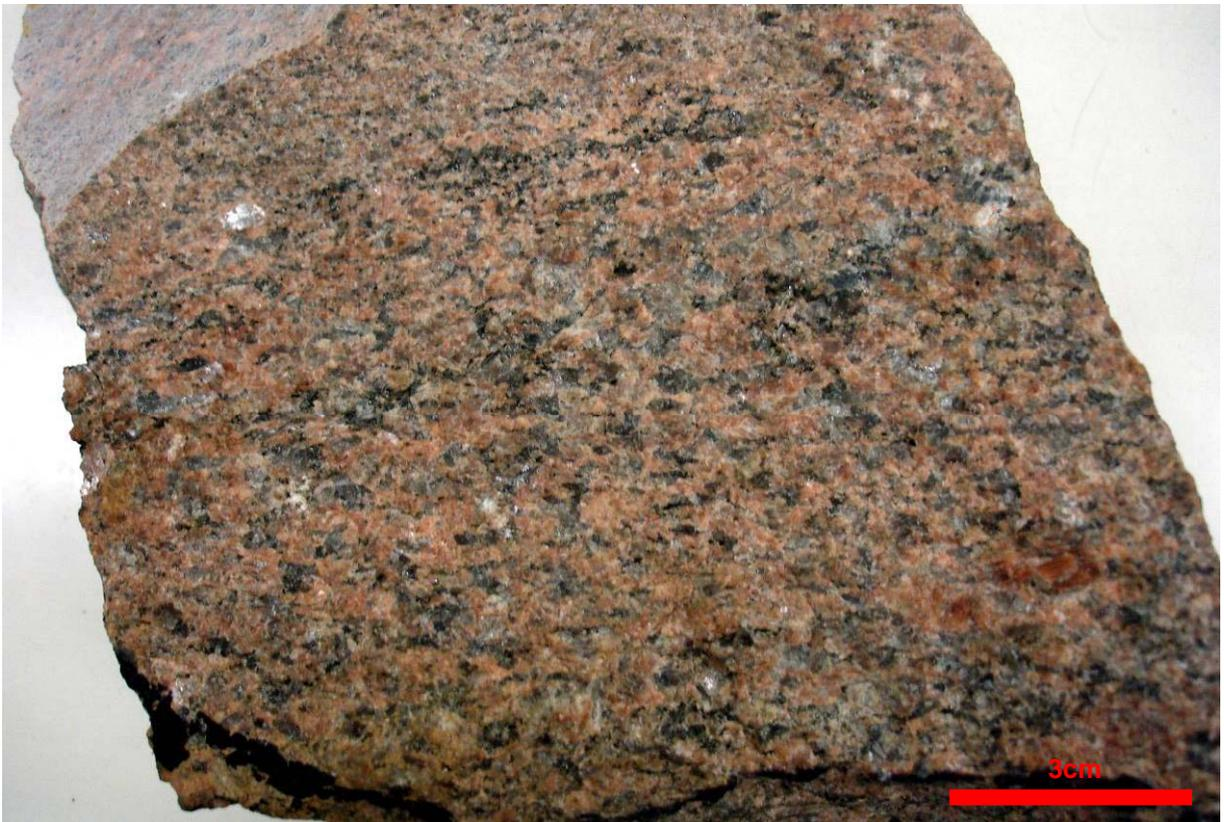
**Fotografia 3.3j:** Textura inequigranular porfírica subordinada a deformação em amostra do granito Serra da Mangueira (ponto FSR065)
