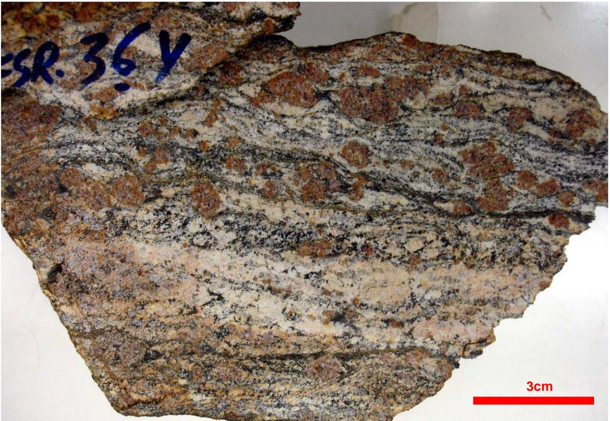
**Fotografia 3.3i:** amostra de Grt-Sil-Kfs-Bt-xisto migmatítico (ponto FSR036)
