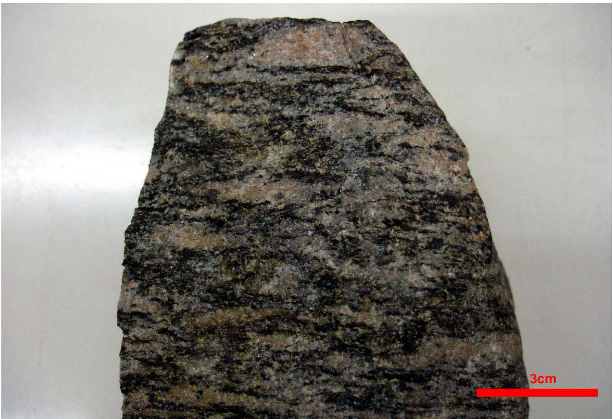
**Fotografia 3.3s:** textura inequigranular porfírica subordinada à deformação em amostra de Hbl-Bt-ortognaisse da Unidade Candelária. Augens de Kfs (Ponto FSR127)
