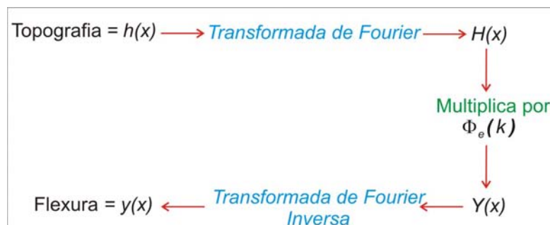
Figura 6.5: Esquema para representar os principais passos na filtragem no domínio da frequência e do espaço de um conjunto de dados topográficos (Watts 2001).
