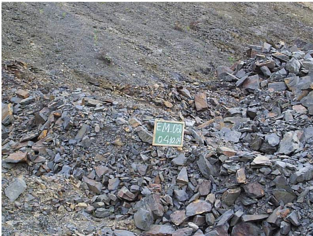
Figura nº 13- Argilito da Formação Palermo,(popularmente denominado de Taguá), endurecido, explorado para uso em olarias. Coordenada 655.544E/6.847.376N, localidade de Belvedere, município de Urussanga.
