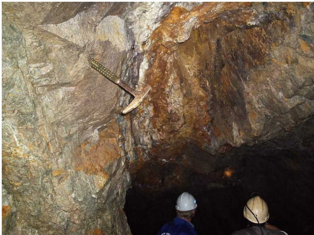
Figura nº 24 - Veio de Fluorita principal espessura de 4,6 metros galeria nível 250 metros.
