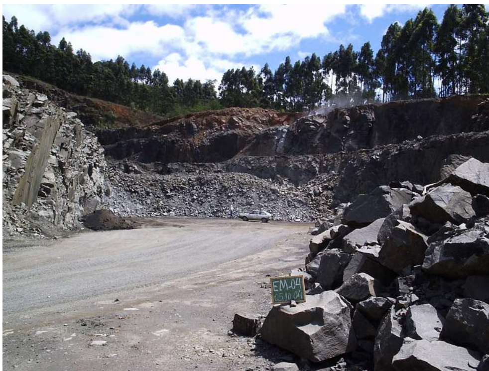
Figura nº 16- Coordenada 664.754E/6.851.392 N, Extração de Basalto para brita – SETEP, localidade de Rio Maior, município de Urussanga.
