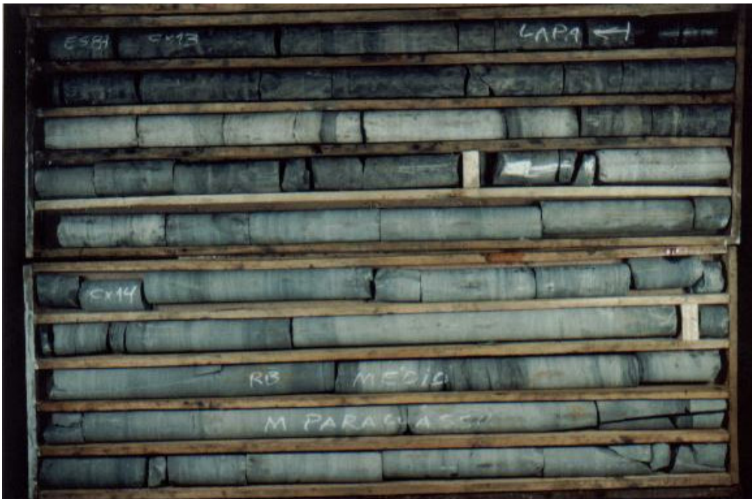
Figura 19: Membro Paraguaçu. Intercalação de siltitos e arenitos finos com estratificação ondulada. Testemunhos de sondagens do furo PTR 02, próximo à cidade de Treviso.
