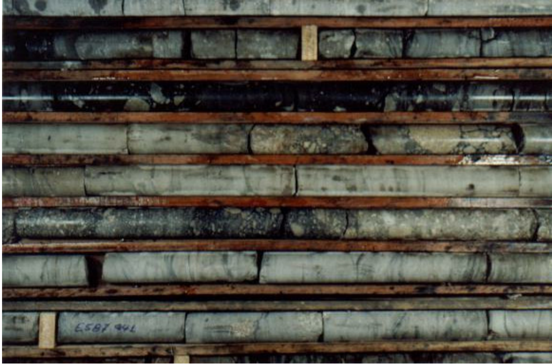
Figura 50: Conglomerado com seixos de composição granítica. Fácies basal da Formação Rio do Sul. Local Furo PTR-03, junto à cidade de Treviso.
