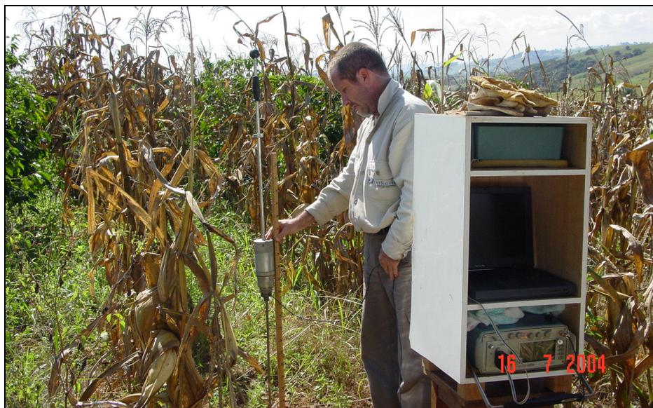
Figura 7.7 – Ensaio de medida de resistência a penetração realizada em campo.
