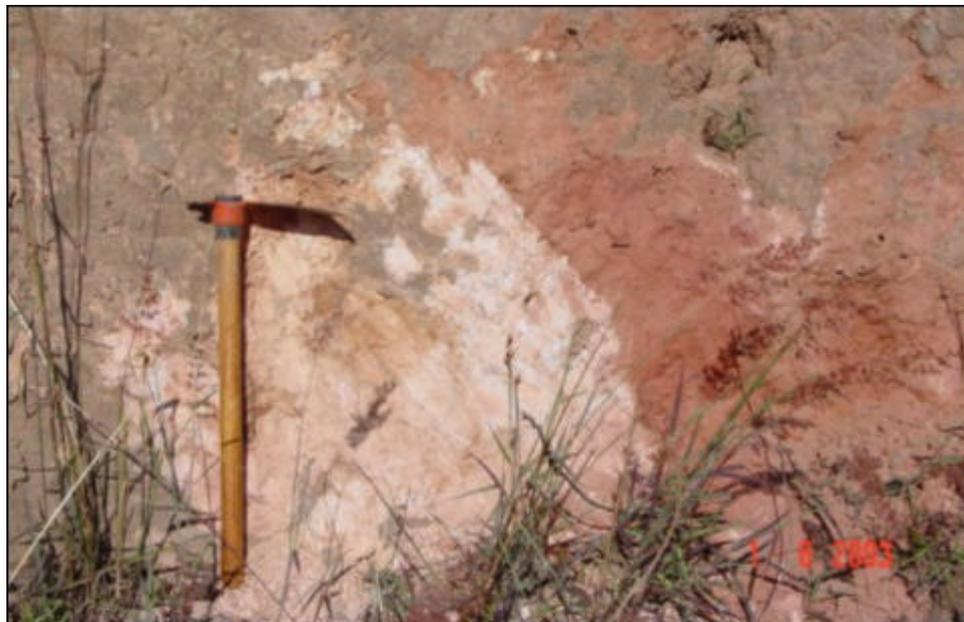
Figura 5.76 Diferença de coloração observada em afloramentos de solos de migmatito resultante das diferenças de concentração mineralógica da rocha.
