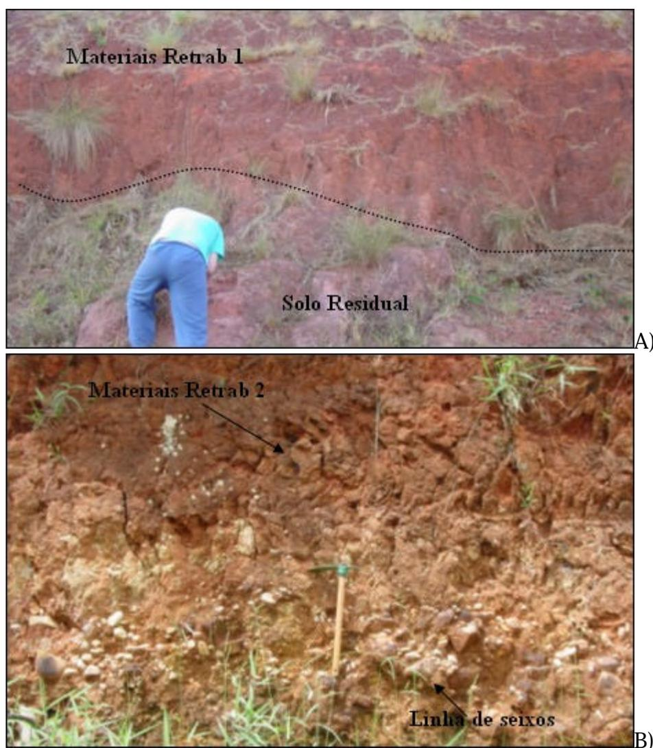
Figura 5.62.A) Ocorrência de materiais retrabalhados presente sobre residuais sem linha de seixo.B) Linha de seixos separando materiais retrabalhados e residuais.
