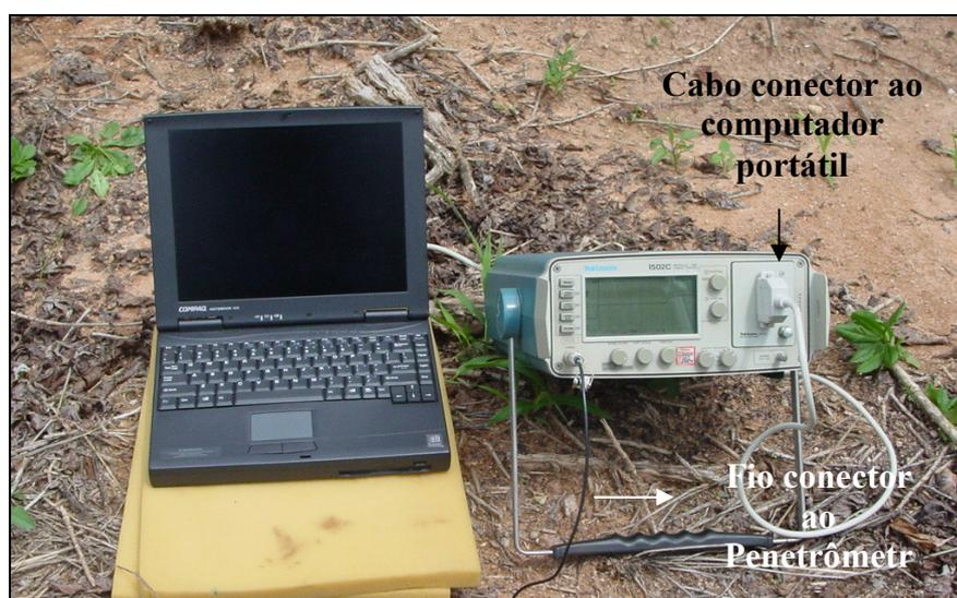
Figura 7.3 – Equipamentos utilizados para aquisição de medidas de  $\epsilon_b$  e  $\theta$  em campo.
