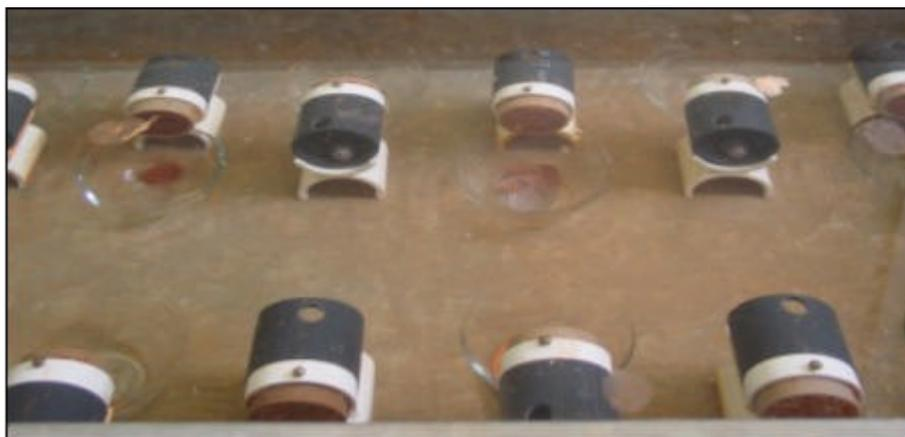
Figura 5.61. Ilustração do conjunto anel/solo imerso em recipiente com água para execução do ensaio de perda de massa por imersão.
