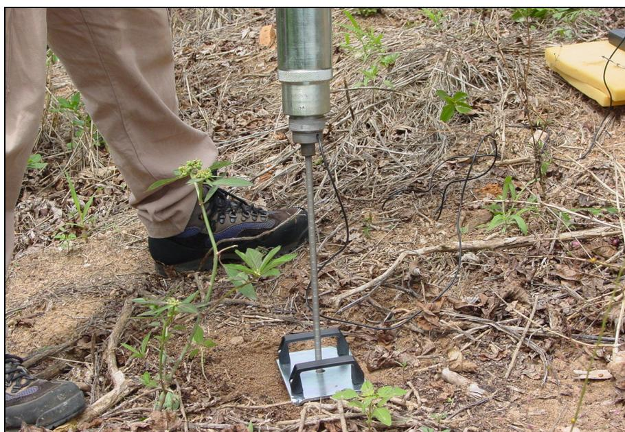
Figura 7.8 – Detalhe cravação do penetrômetro em ensaios de campo.
