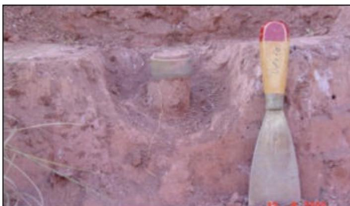
Figura 5.59. Coleta de amostra indeformada para execução dos ensaios de absorção de águas e perda por imersão.
