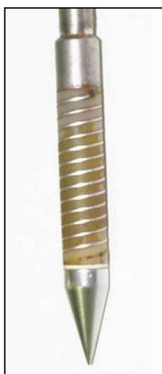
Figura 7.2 – Detalhe da sonda espiral de TDR. Fios metálicos envoltos em um material plástico duro (Kevlar-Nylon).
