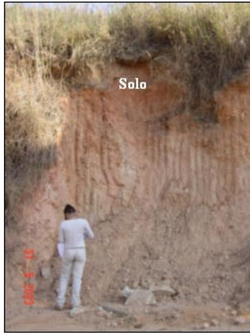
Figura 5.69. Exposição de pacote de solos residuais de gnáissicas intercalados com quartzito.
