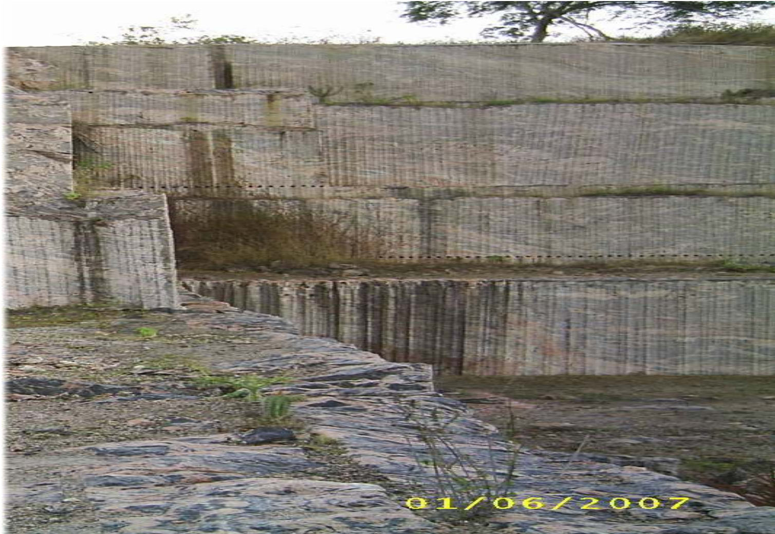
Foto 2.21 - Frente de lavra, em bancadas baixas, da Pedreira do Sítio Tio Jaú.
