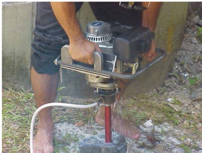
Figura 9: Sonda Portátil utilizada na obtenção de testemunhos.
