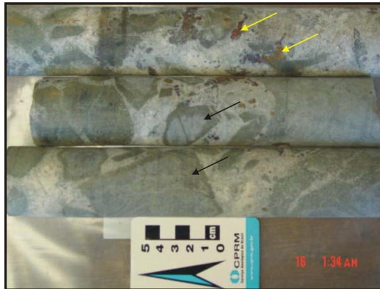
**Figura 50** – Fotografia de testemunho de brecha não mineralizada, mostrando, com a seta amarela, disseminação de sulfeto e, com a seta preta, fragmentos de rochas máficas. Amostra F-314, corpo Sossego.
