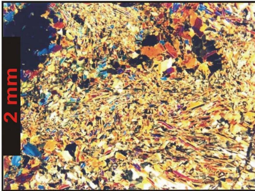
**Figura 24** - Fotomicrografia de actinolito típico, isótropo e formado essencialmente por cristais de actinolita de tamanhos variados. Amostra F-352/ 93,8m, corpo Sequeirinho. (Luz transmitida, nicóis X).
