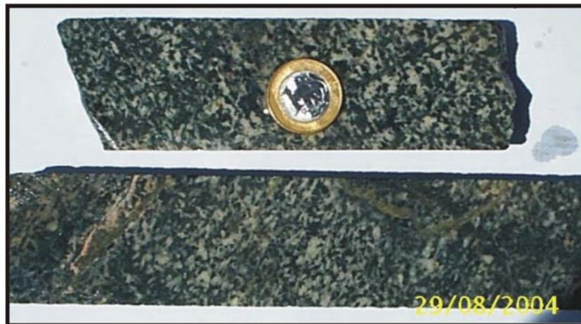
**Figura 20** – Fotografia de testemunho de furo de sondagem de gabro pouco alterado. (Furo F-204 – corpo Sequeirinho).
