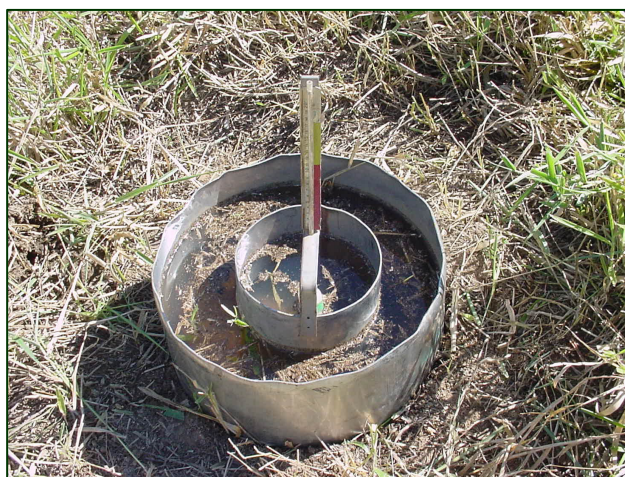
Figura IV.4 – Infiltrômetro de duplo-anel
