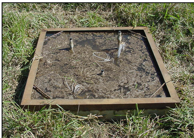
Figura IV.3 –Tabuleiro de inundação do teste de capacidade de campo in situ .
