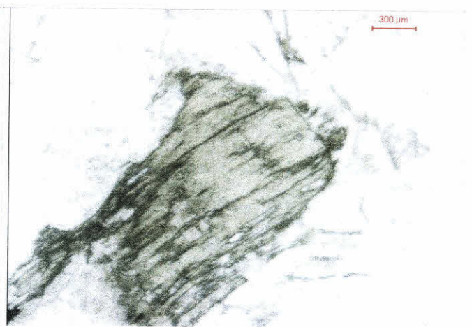
Fotomicrografia 530 – Cristal de biotita quase totalmente transformado em clorita. Amostra HDS 37.
