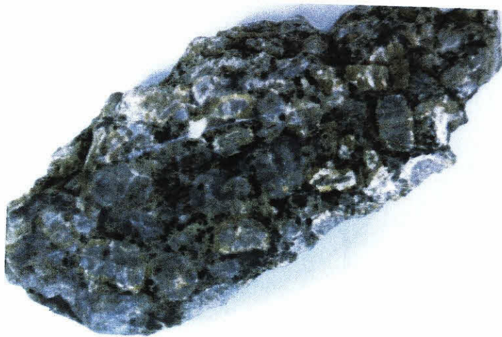
Figura 3.3.1 – Amostra do MGRSF que apresenta textura viborgítica e orto a mesocumulática (amostra HDSrapa1, fácies SF4).
