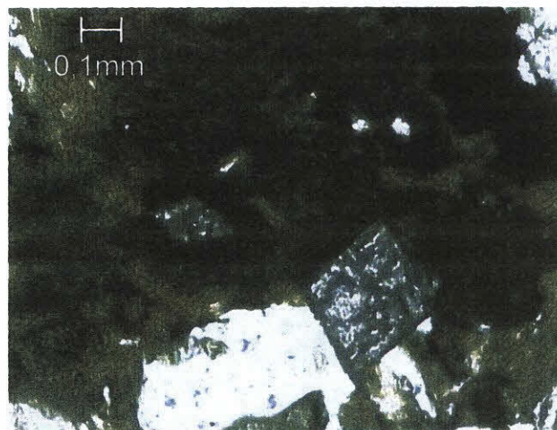
Fotomicrografia 553 – Cristais de zircão euédricos, associados à minerais opacos e biotita (amostra HDS 36).
