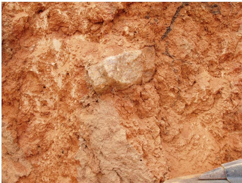
**Figura 22 – “stone-line” separando o segundo e o terceiro nível amostrado**
