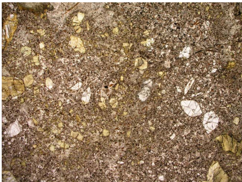
Figura 7: Seção delgada do lamprófiro encaixante mostrando feno/xenocristais de olivina euédrica a subédrica em matriz fina. Lado maior da foto: 10,4 mm.
