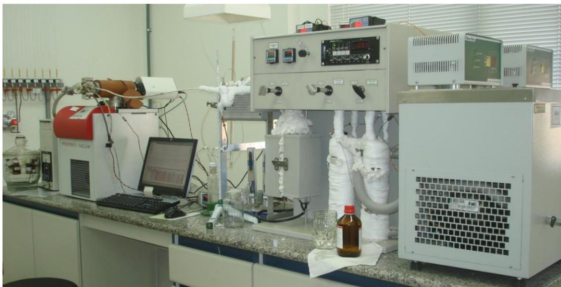
Figura 3.10 - Unidade multipropósito acoplada a um espectrômetro de massas Balzers Omnistar utilizada para os experimentos de TPSR.
