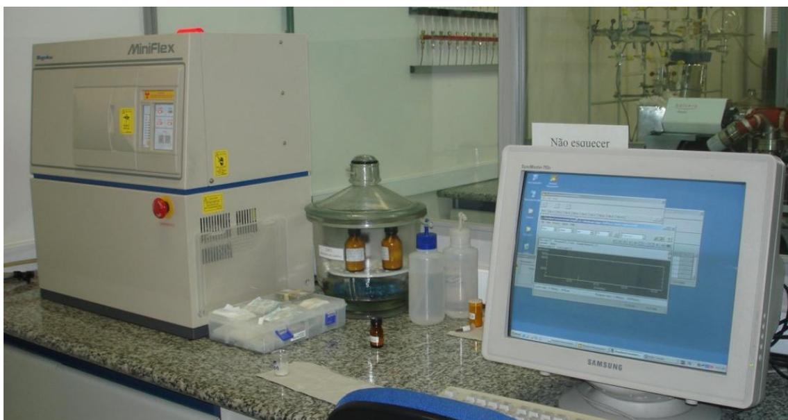
Figura 3.2 - Equipamento de difração de raios X (RIGAKU modelo Miniflex).
