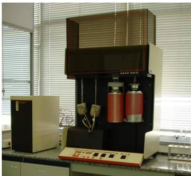
Figura 3.1 - ASAP (Accelerated Surface Area and Porosimetry System) Micromeritics 2010, equipamento utilizado para fazer medida de área BET.
