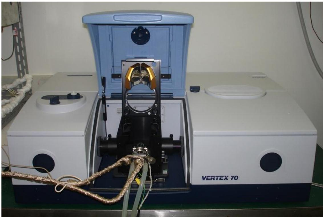
Figura 3.6 - Espectrômetro VERTEX 70 da Bruker
