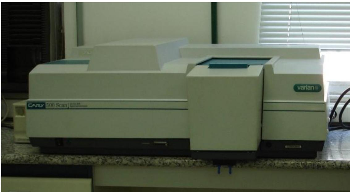
Figura 3.3 - Espectrofotômetro VARIAN – Cary 500.
