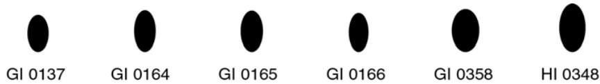
FIGURA 62 – Ilustração esquemática da forma dos cristais de minerais de ferro, de acordo com o grau de alongação médio, das subfrações nucleantes dos diferentes tipos de minérios.
