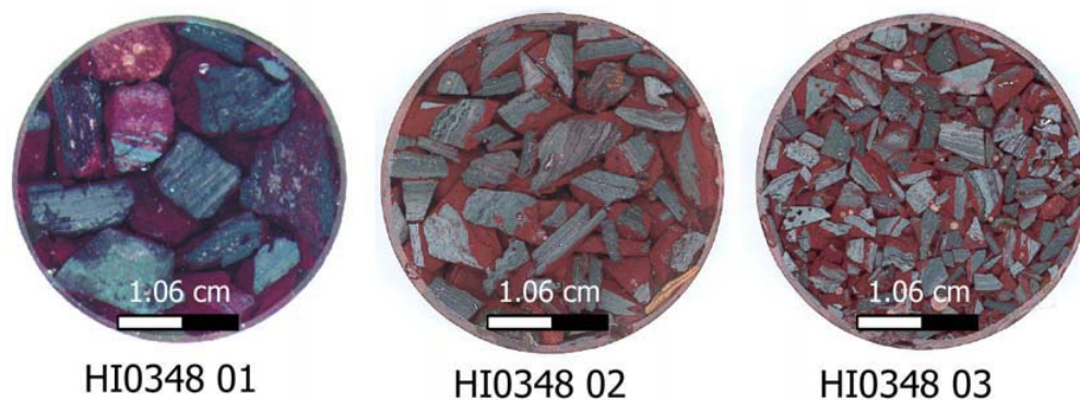
FIGURA 52 – Seções polidas das subfrações nucleantes do sinter feed do minério HI 0348.
