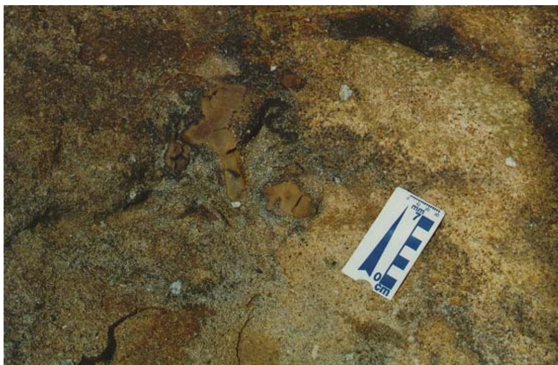
Foto 4.10. Detalhe do arenito silicificado da Lagoa do Queimado (Pendências - RN). Notar a deposição de calcedônia nos interstícios e fraturas da rocha, representada pelo material de cor marrom (Folha SB.24-X-D-II, UTM: 757,826kmE e 9.420,104kmN).
