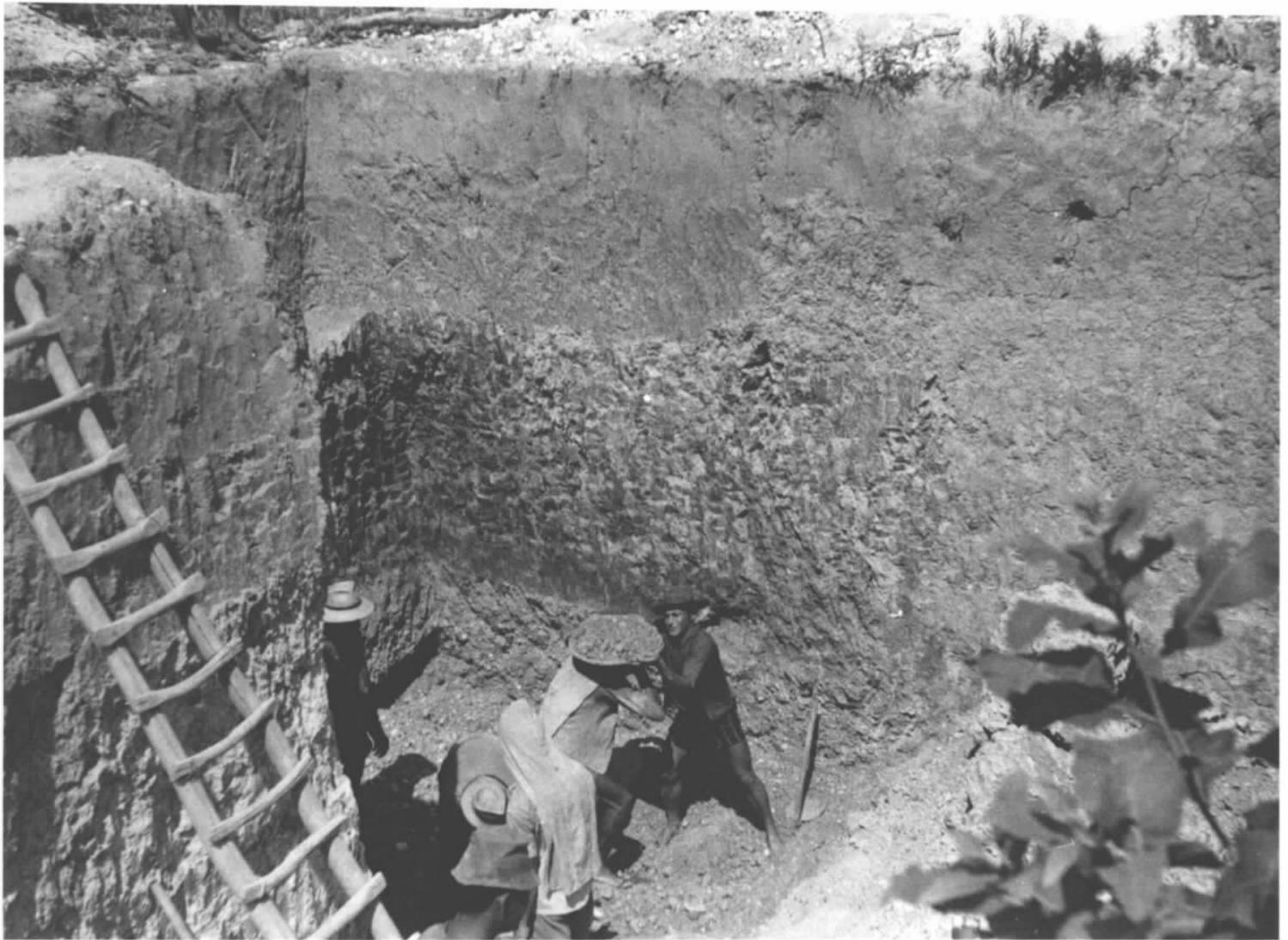
FOTO 20 - Cata - Retirada manual do cascalho em recipientes denominados "carumbés". O fundo da cata é alcançado através de uma escada. Município de Alto Paraguai-MT.
