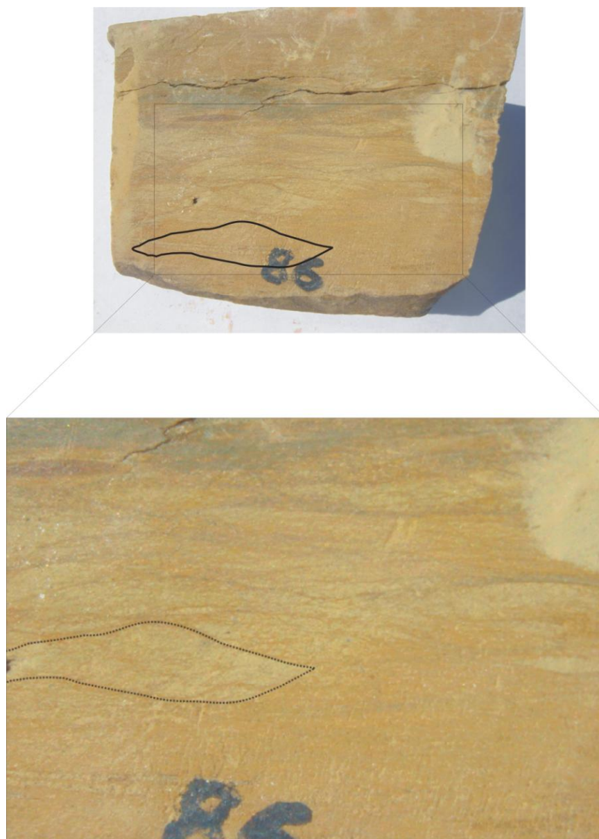
4.29 - Amostra de mão contendo púmices sigmoidais realçadas pela linha em preto, bastante compactada, caracterizando o ignimbrito. Ponto NXT 86.
