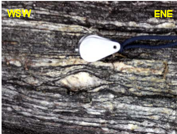
Fotografia 4.12- Porfiroclasto do tipo sigma em paragnaisse, indicando movimento dextral (lagedo) (porção norte da área). Foliação: 261\text{Az}/88^\circ/351\text{Az} .
