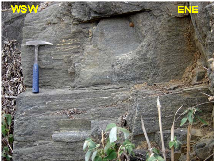
Fotografia 4.10- Paragneisse com granulação fina, em corte, foliação verticalizada e lineação horizontal (porção norte da área). A foliação é 253\text{Az}/89^\circ/343\text{Az} .
