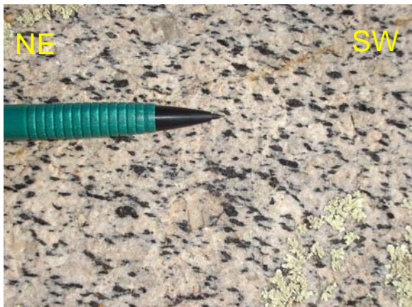
Fotografia 3.11- Leucogranito, a porção cuja textura mais difere do restante dos granitos observados em campo. Apresenta foliação magmática, mostrada na fotografia. Encontra-se a norte da ZCCCN, bem próxima à mesma. A foliação é 115Az/61°/205Az.
