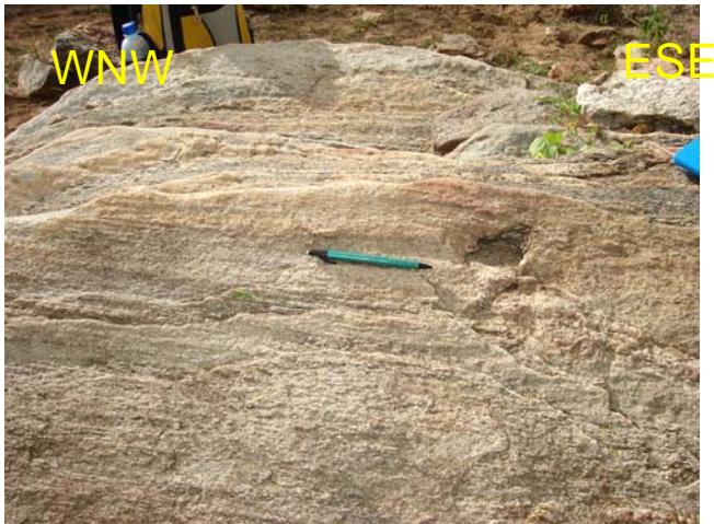
Fotografia 3.6- Quartzito que intercala com xisto a sul da ZCCCN. A foliação é 93Az/31^\circ/183Az .
