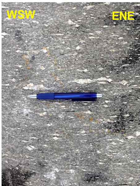
Fotografia 4.5- Grãos de feldspato com baixa assimetria indicam movimento sinistral (lagedo). Foliação: 85Az/71°/175Az, na região da ZCCCN
