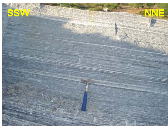
Fotografia 3.15- Granito bandado, com foliação de 285\text{Az}/30^\circ/15\text{Az} .
