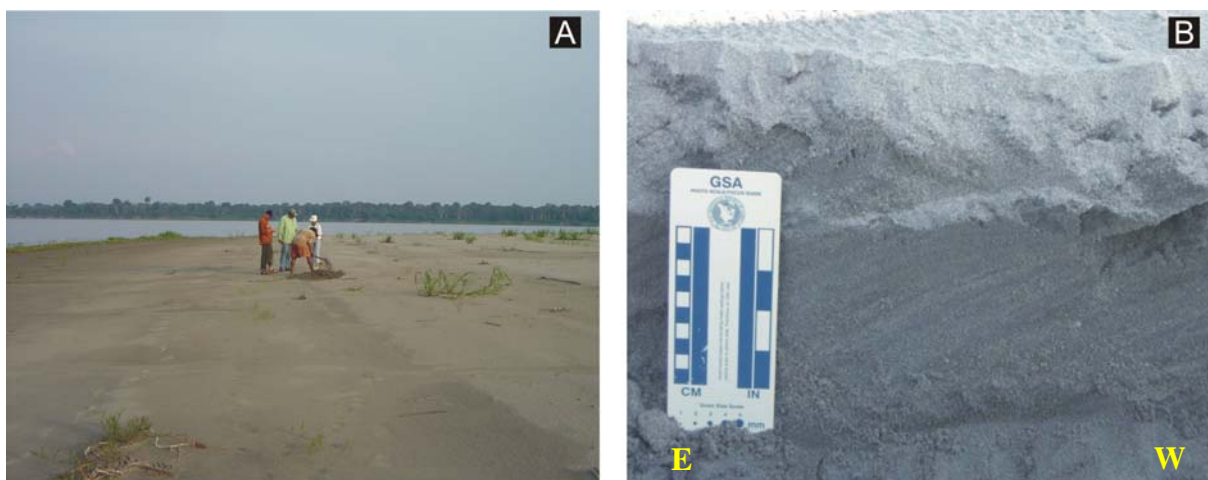
Figura 3. A) Coleta de sedimentos recentes ao longo da calha do rio Solimões e B) Estratificação cruzada tabular, com paleocorrentes indicando o sentido de migração para leste.
