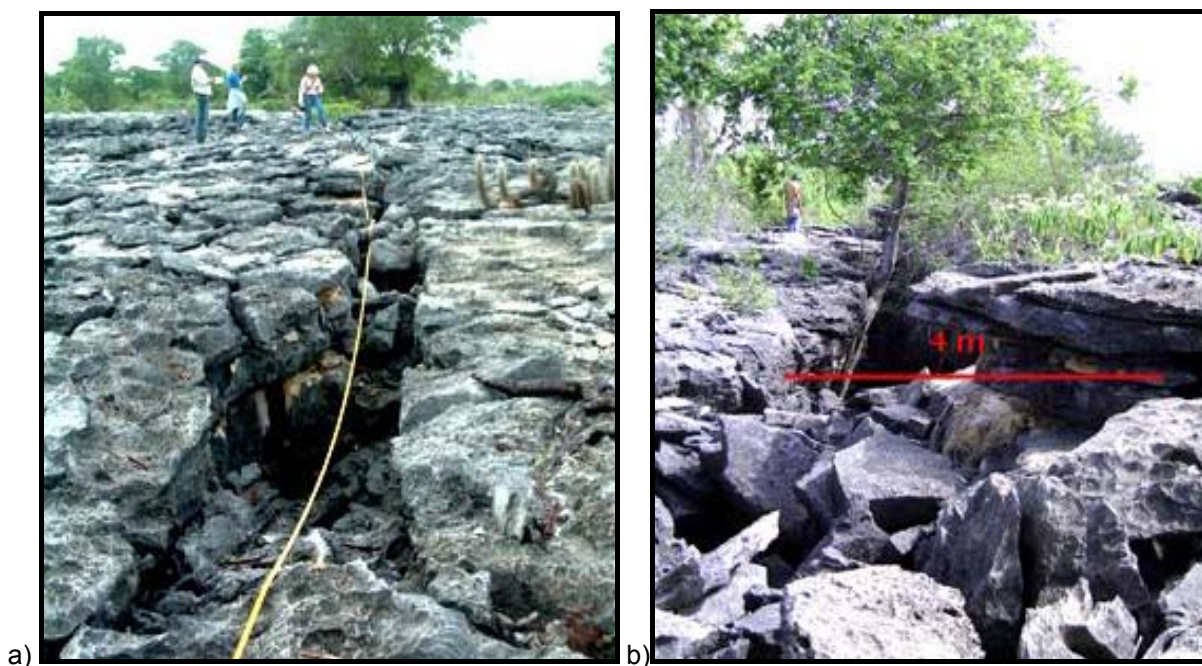
FIGURA 4.23 – a) Método de medição da abertura e comprimento das falhas mapeadas; b) Falha classificada como cavernosa (4 m) (Coord. UTM-WGS 84: 652.303/9.389.844 e 653.672/ 9.388.782).
