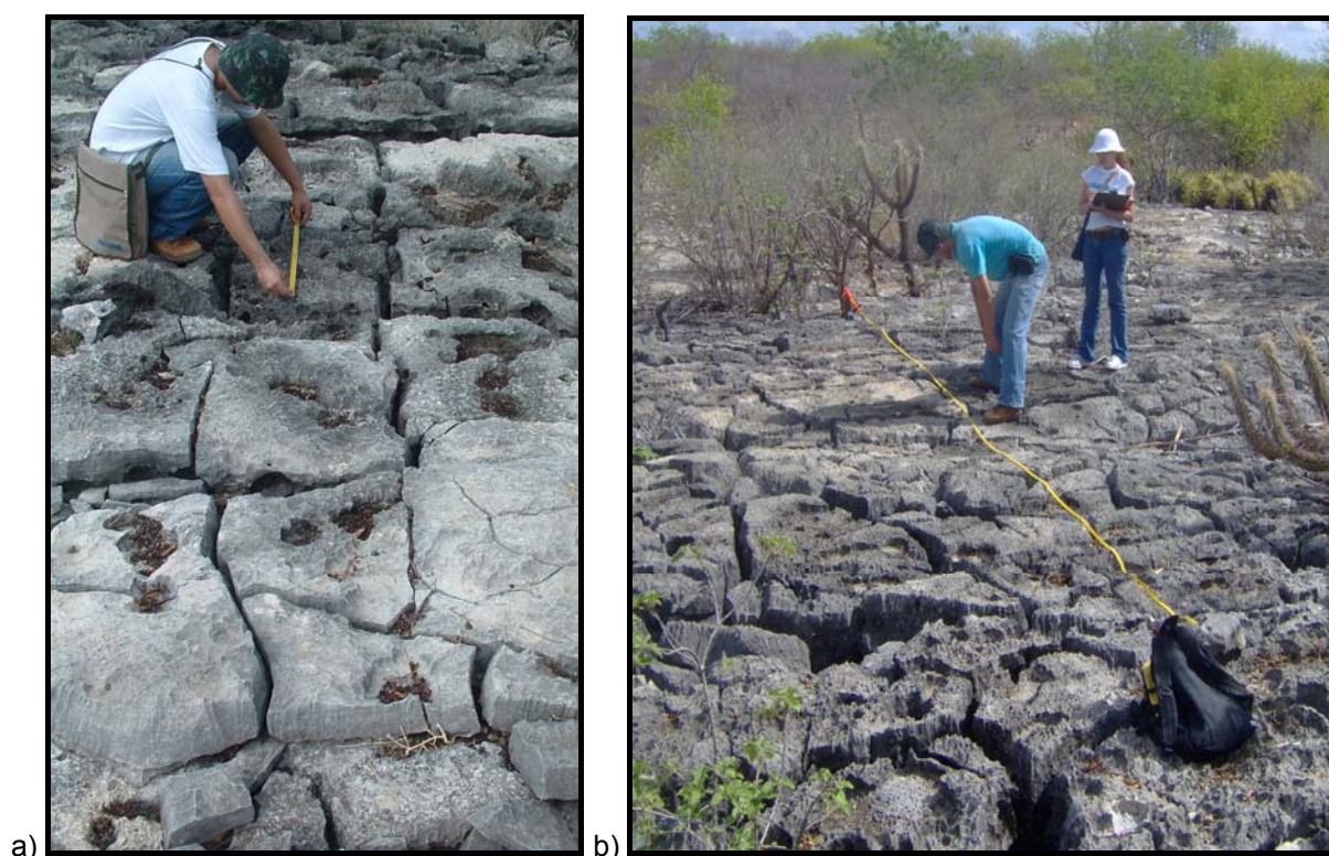
FIGURA 4.12 – Levantamento sistemático das juntas pelo método da linha, através da medida das distâncias entre fraturas sucessivas de um mesmo conjunto (a), longo de uma linha de dez metros de comprimento (b), perpendicular a direção de cada uma das quatro famílias identificadas – J_1 , J_2 , J_3 e J_4 (Coord. UTM-WGS 84: 651.645/9.388.380 e 652.000/9.388.814).
