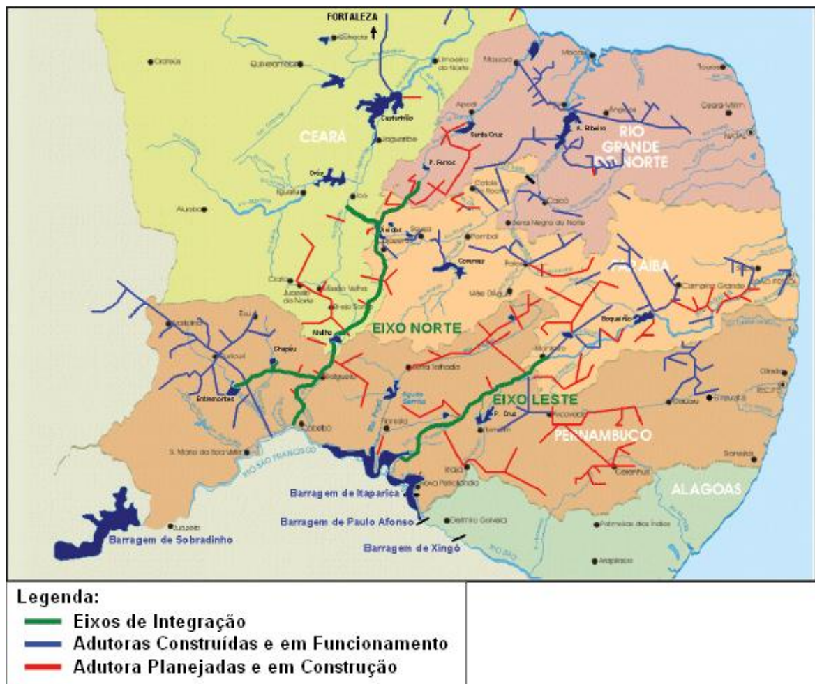
Figura 19 - Esquema geral do projeto de transposição, evidenciando os Eixos Norte e Leste, com o traçado aproximado das adutoras a serem interligadas. Fonte: CIRILO, 2008.
