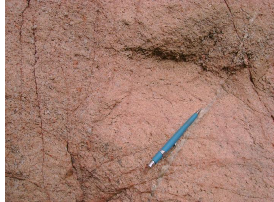
Figura 3-34: Foto do biotita granito fanerítico, hololeucocrático, cor vermelha a rosa clara, granulação fina a média, do Granito São Domingos (NP3γ2lsd) com vênulas sub-centimétricas. (Afloramento localizado na estação de ASM 35, 4 km a sudeste do Bairro São Domingos, Sengés-(PR)
