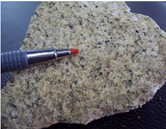
Figura 3-20: Foto do biotita granito fanerítico leucocrático de cor branca, do Granito Ouro Verde (NP3γ2lov). (Afloramento localizado na estação de ASM 23, Ouro Verde, Sengés-PR)
