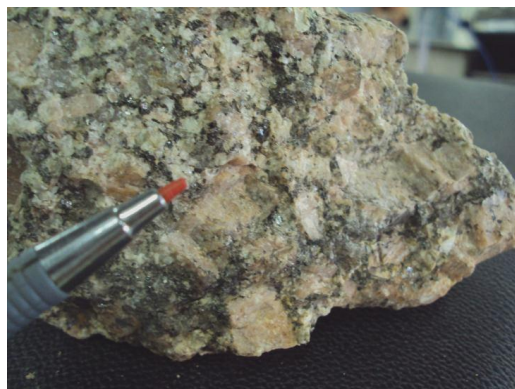
Figura 3-25: Foto do biotita granito porfirítico com matriz de granulação grossa com fenocristais idiomórficos de K-feldspato. (Afloramento localizado na estação de ASM 26, Caçador, Doutor Ulysses-PR)
