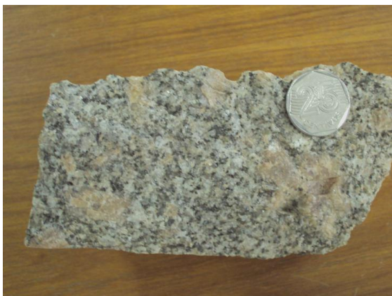
Figura 3-26: Foto do biotita granito porfirítico, com matriz de granulação média, leucocrático e cor branca a rosa clara do Granito Patrimônio Santo Antônio (NP3γ2lpa). (Afloramento localizado na estação de ASM 48, Caçador, Doutor Ulysses-PR)
