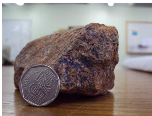
Figura 3-16: Biotita sienogranito fanerítico de cor vermelha com veios de fluorita (cor roxa) do Granito Santa Rita (NP3 \gamma 2lsr). (Afloramento localizado na estação de ASM 55, Caçador, Doutor Ulysses-PR)
