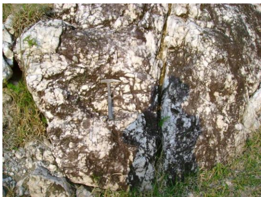
Figura 3-4: Foto de quartzitos/metarenitos de granulação fina a muito fina, cor branca, maciço e intensamente fraturado da Formação Serra dos Macacos (NP1iq). (Afloramento SW- 136, Bairro das Almas, Bom Sucesso de Itararé-SP)
