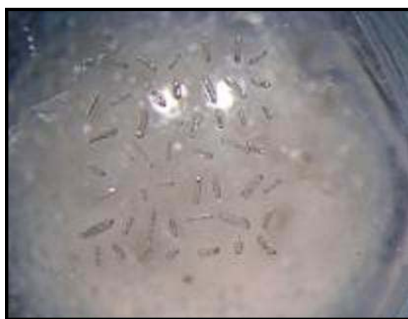
Figura 02. Imagem em lupa de zircões selecionados para datação do granito Silva Jardim.
