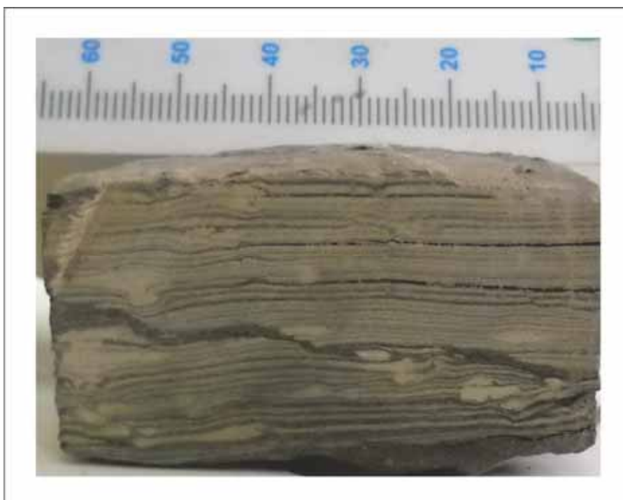
Figura 55 – Calcário laminado com lamelas carbonosas e concreções carbonáticas da microfácies m6 (54,35m).
