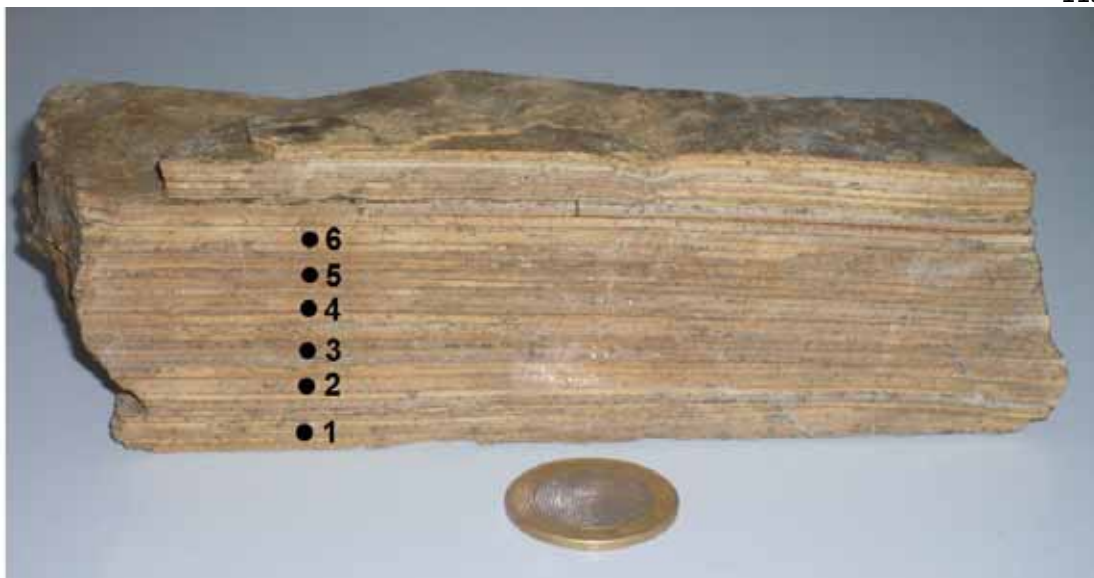
Figura 84 - Calcário laminado da microfácies m5, mostrando os pontos onde foram coletadas amostras das lâminas para as análises isotópicas de oxigênio e carbono.
