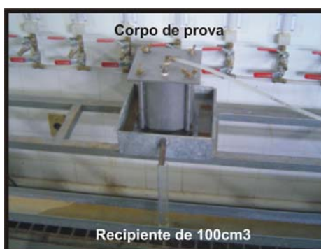
Figura 4.13: Detalhe do corpo de prova saturado no painel de permeâmetro.
