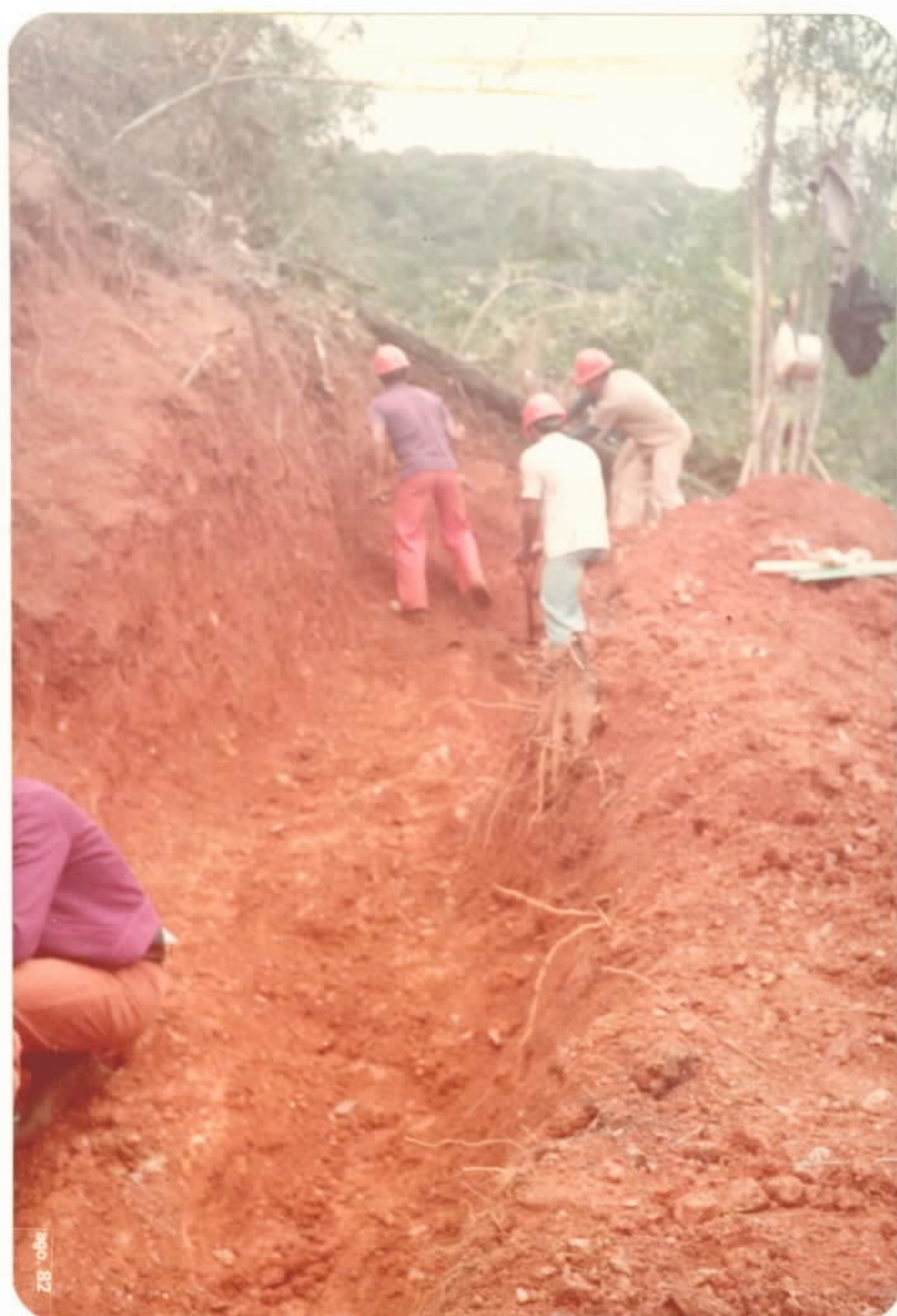
Abertura manual de trincheiras, objetivando a descoberta de zonas mineralizadas.
