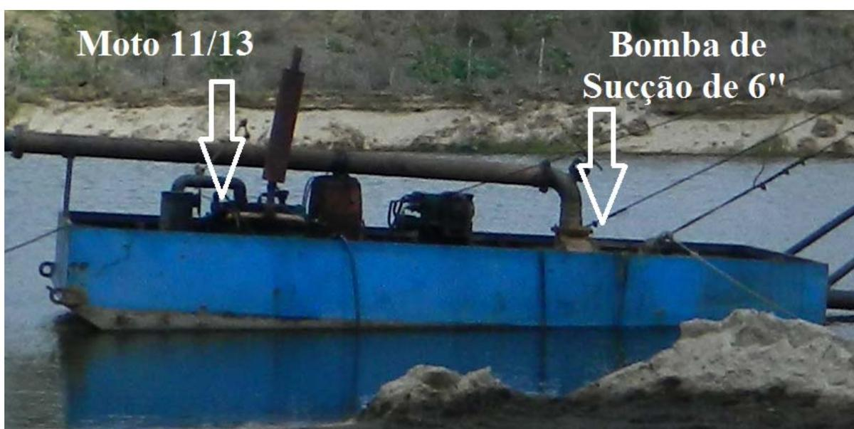
**Figura 68 – Draga com bomba de sucção de 6" (seis polegadas) acoplada a motor diesel de 6 cilindros 11/13 comumente utilizada na exploração de areia na RMN (no município de Ilmo Marinho).**
