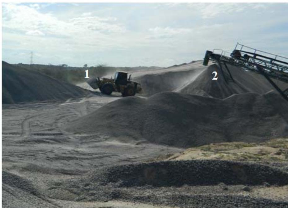
**Figura 63 – Carregamento para expedição pela forma mecanizada (1, com pá carregadeira) ou automatizada (2, diretamente das correias, Pedreira Potiguar, localizada em Macaíba (localidade Jundiá).**
