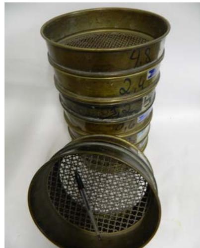
**Figura 9 – Série de peneiras utilizadas nos ensaios de agregados miúdos (areias).**
