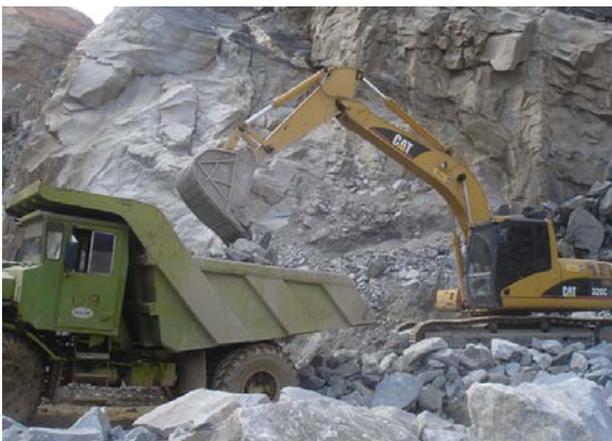
**Figura 27 - Carregamento do material desmontado com escavadeira hidráulica (etapa 2).**
