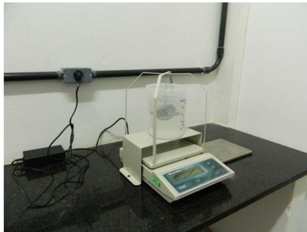
**Figura 8 – Balança com resolução de 0,01g, utilizada nos ensaios, LAPLA/UFPE.**
