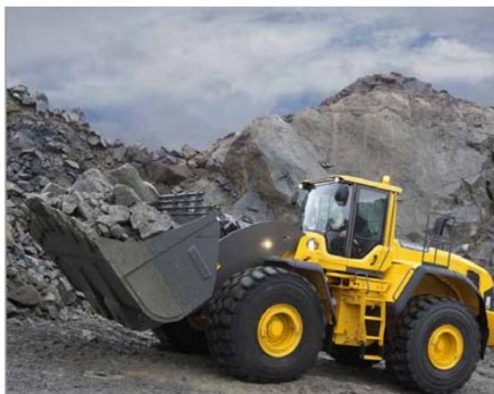
**Figura 28 - Carregamento do material desmontado com pá-carregadeira (etapa 2).**
