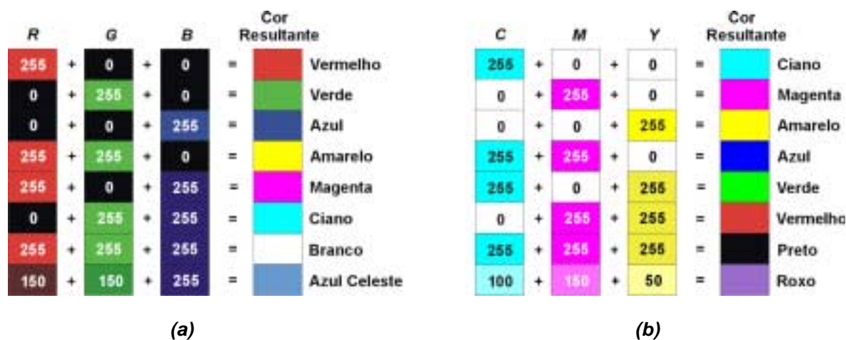
Figura c.1 – Esquema de Formação de Cores nos Sistemas RGB(a) e CMY(b)
