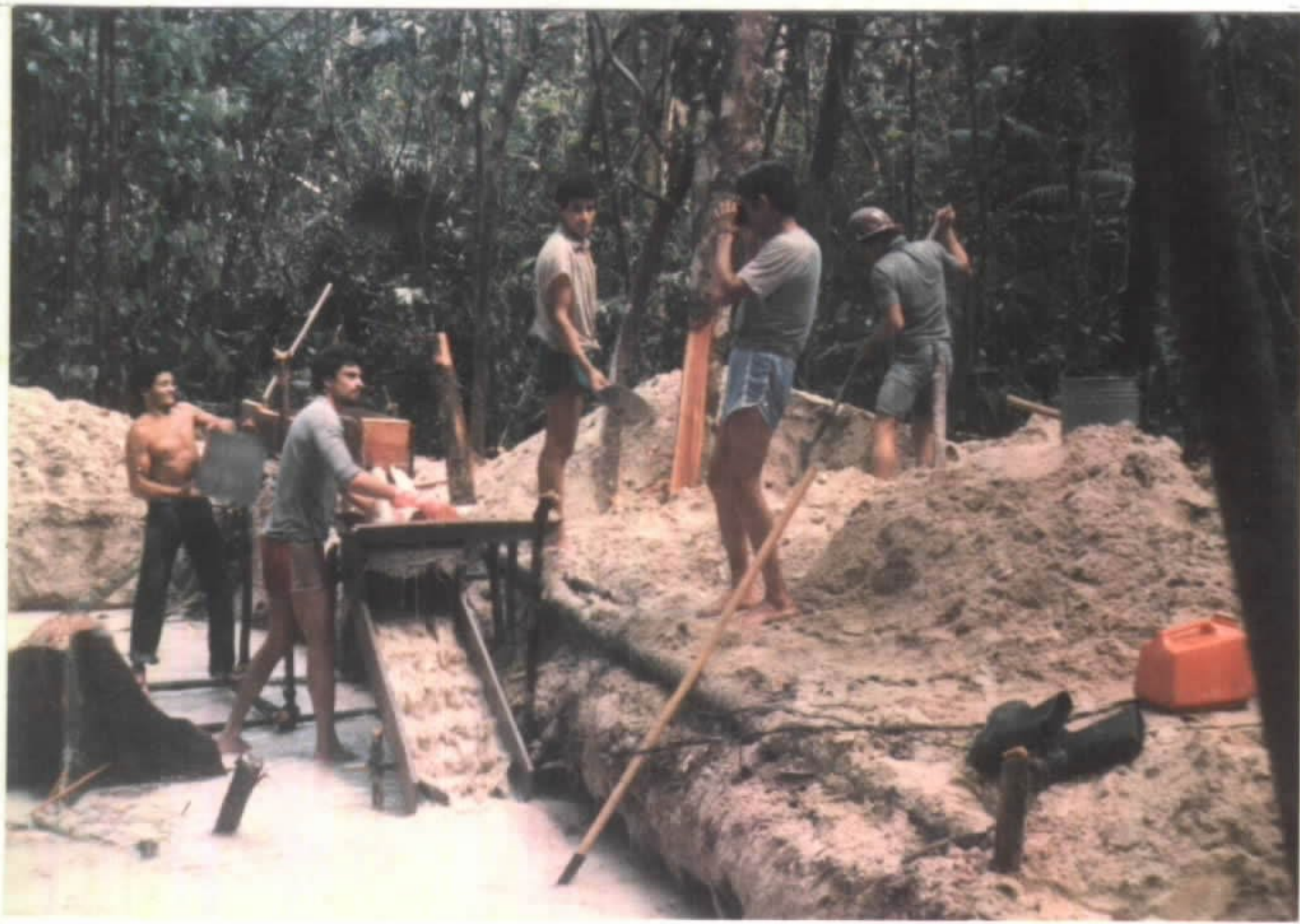
LAVAGEM DO CASCALHO DE UM BARRANCO NO IG. DO ESTALO
