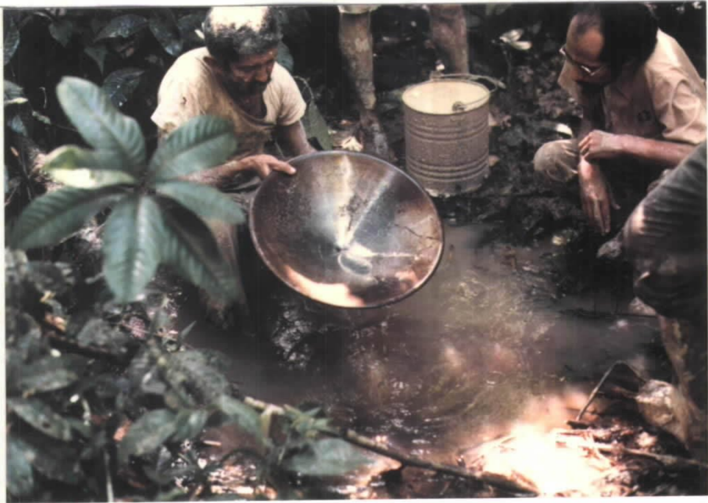
AMOSTRAGEM DE CONC. DE BATEIA - CAMPANHA DE ABERTU R RA DE POÇOS.
