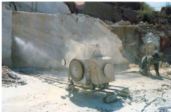
Fig. 12: Corte simples de um plano vertical com fio diamantado (Fonte: Pinheiro, 2003)
