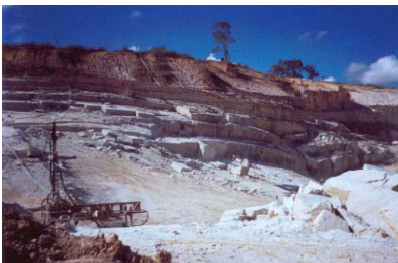
Fig. 4: Lavra por bancada baixa, com degraus controlados por planos de fraturas subhorizontais. Granito “Verde Eucalipto”, ES (Fonte: Pinheiro, 2003)
