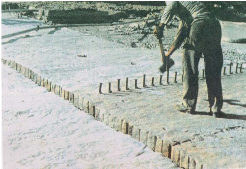
Fig. 20: Corte em granito através de cunhas mecânicas (Fonte: Alencar, Caranassios e Carvalho, 1996)
