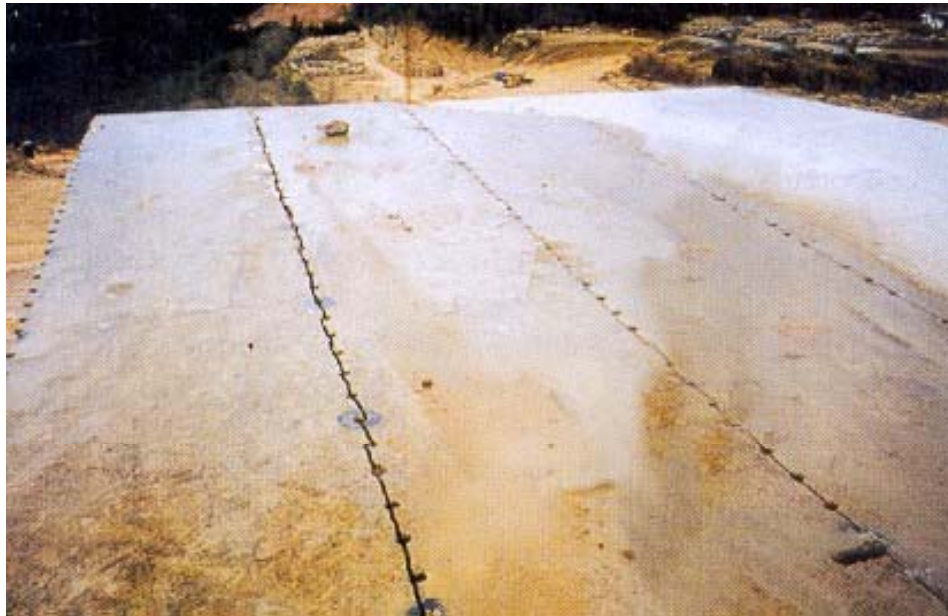
Fig. 21: Corte em granito através de argamassa expansiva. Granito “Amarelo Veneciano”. Notar sua pequena espessura com perda mínima de material (Fonte: Rocha de Qualidade, 1999)
