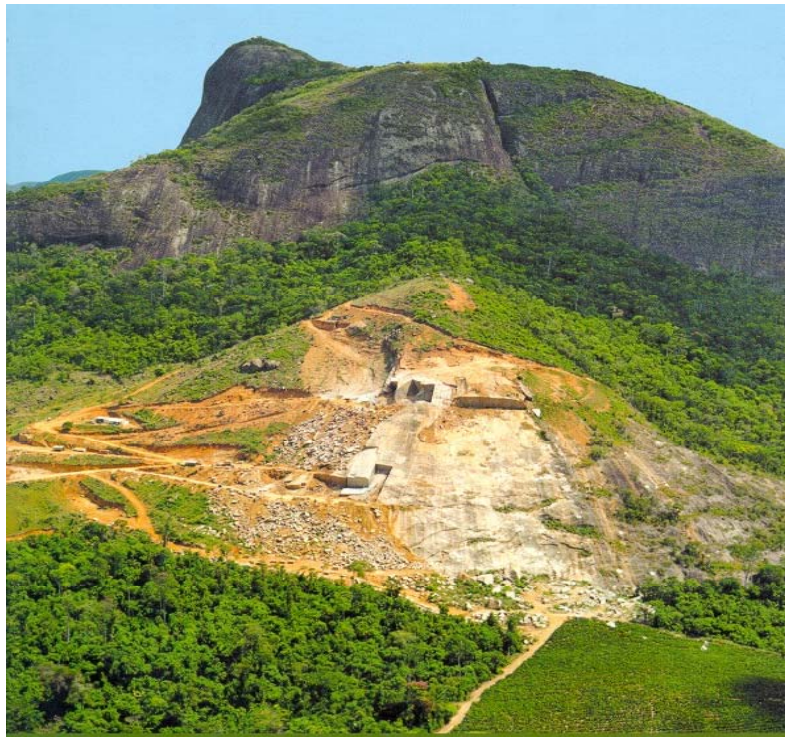
Fig. 7: Lavra por desabamento. Granito “Giallo Speranza”, ES. (Fonte: Mineração Rocha Branca)
