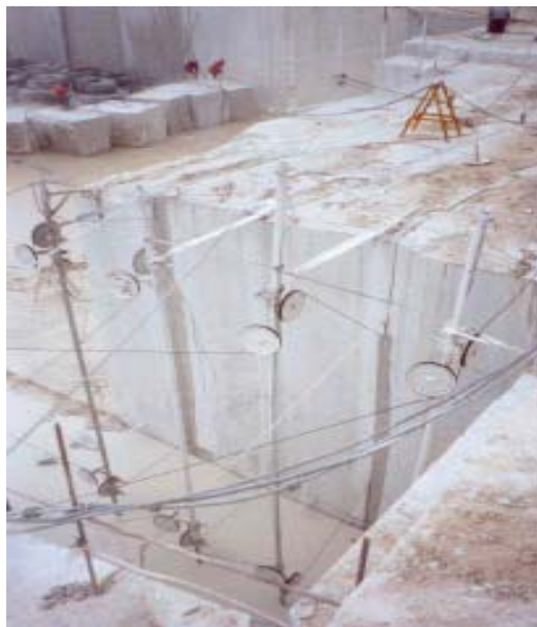
Fig. 14: Cortes verticais em “L” com fio diamantado conjugado com sistema de hastes e polias verticalizadas (Fonte: Pinheiro, 2003)
