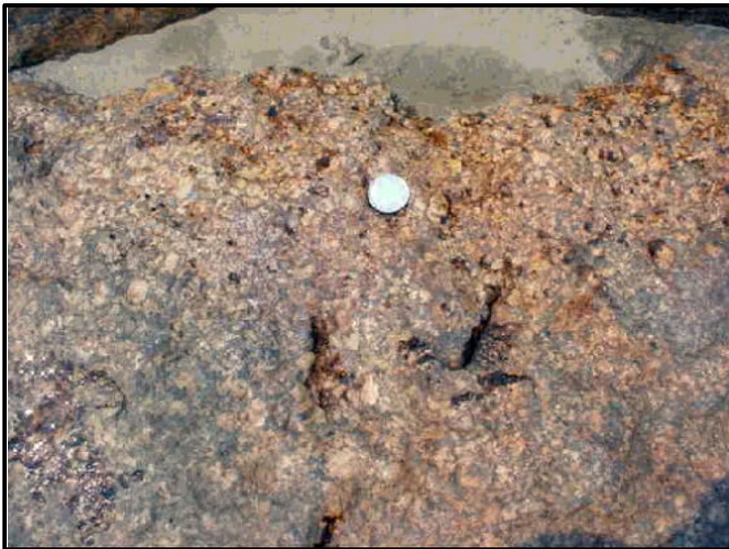
Figura 28 – Textura do sienogranito porfirítico observada no afloramento JG-99.
