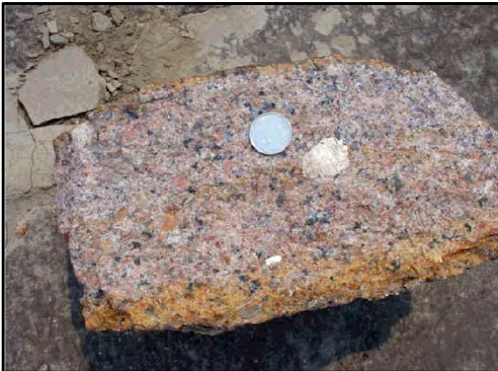
Figura 27 – Textura de outra Fácies (biotita sienogranito porfirítico) observada no afloramento JG-99, contíguo ao ponto JG-104.
