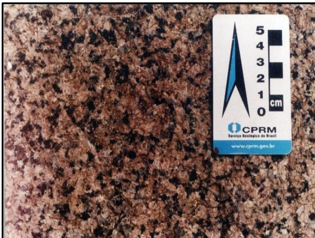
Figura 33 – Feição textural do granito Caracol (afloramento JG-186).
