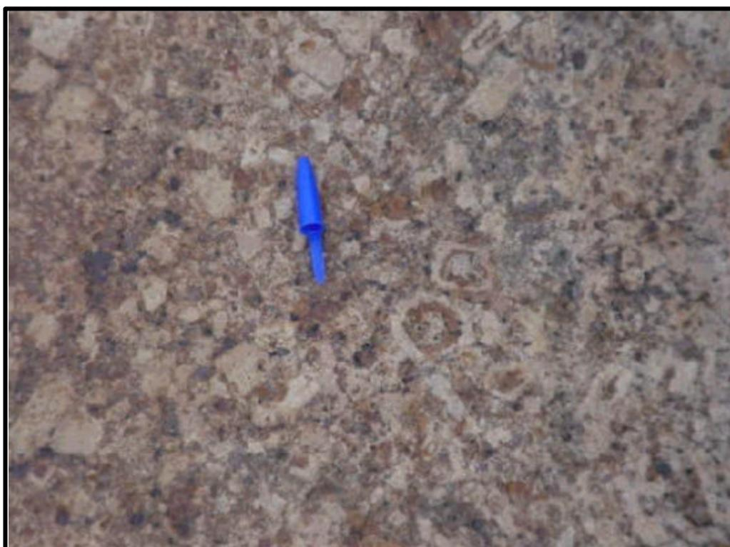
Figura 15 – Textura rapakivi observada no granito de natureza subvulcânica, aflorante no ponto JG-128.
