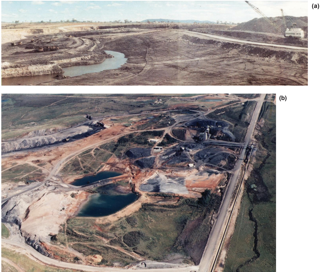
Figura XI.17 – Similaridades entre Minas de Carvão a Céu Aberto. Acima a Mina da Warkworth no Hunter-Valley, Austrália (4 Mta) e abaixo a Mina de Candiota da CRM, RS (2,4 Mta). No canto esquerdo a regeneração ambiental é concomitante à lavra. Na foto inferior (do autor) os pesados caminhões aguardam descarga na moega do britador. Notar a correia transportadora que entrega carvão na Usina Térmica Presidente Médici, situada a 4 km.
