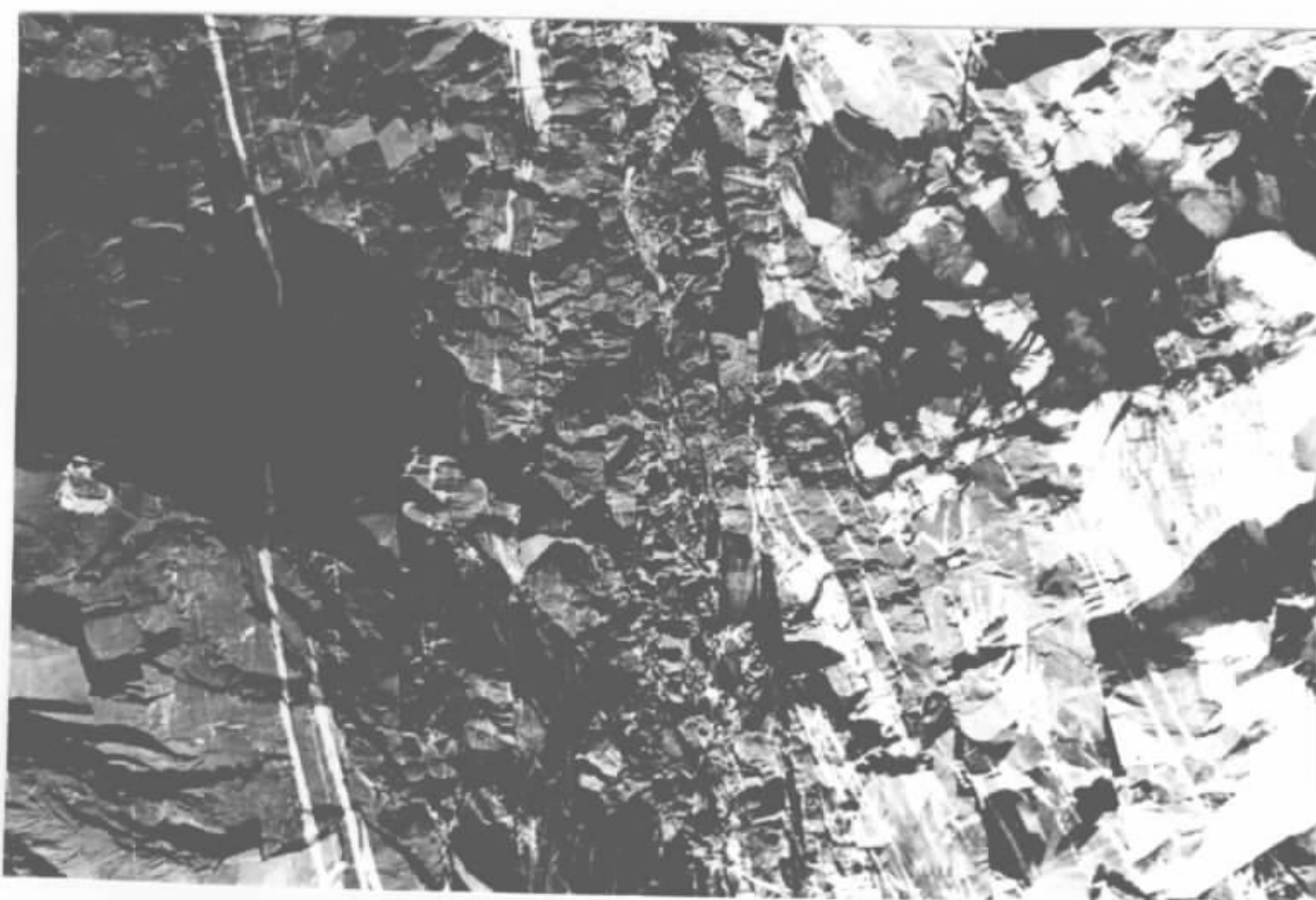
ASPECTO DO CALCÁRIO CINZA ESCURO, GRAFITOSO, DA MINA DA MARINGÁ - Folha de Campina Bonita. Observar mergulhos altos, falhas e a presença abundante de vênulas de calcita.
