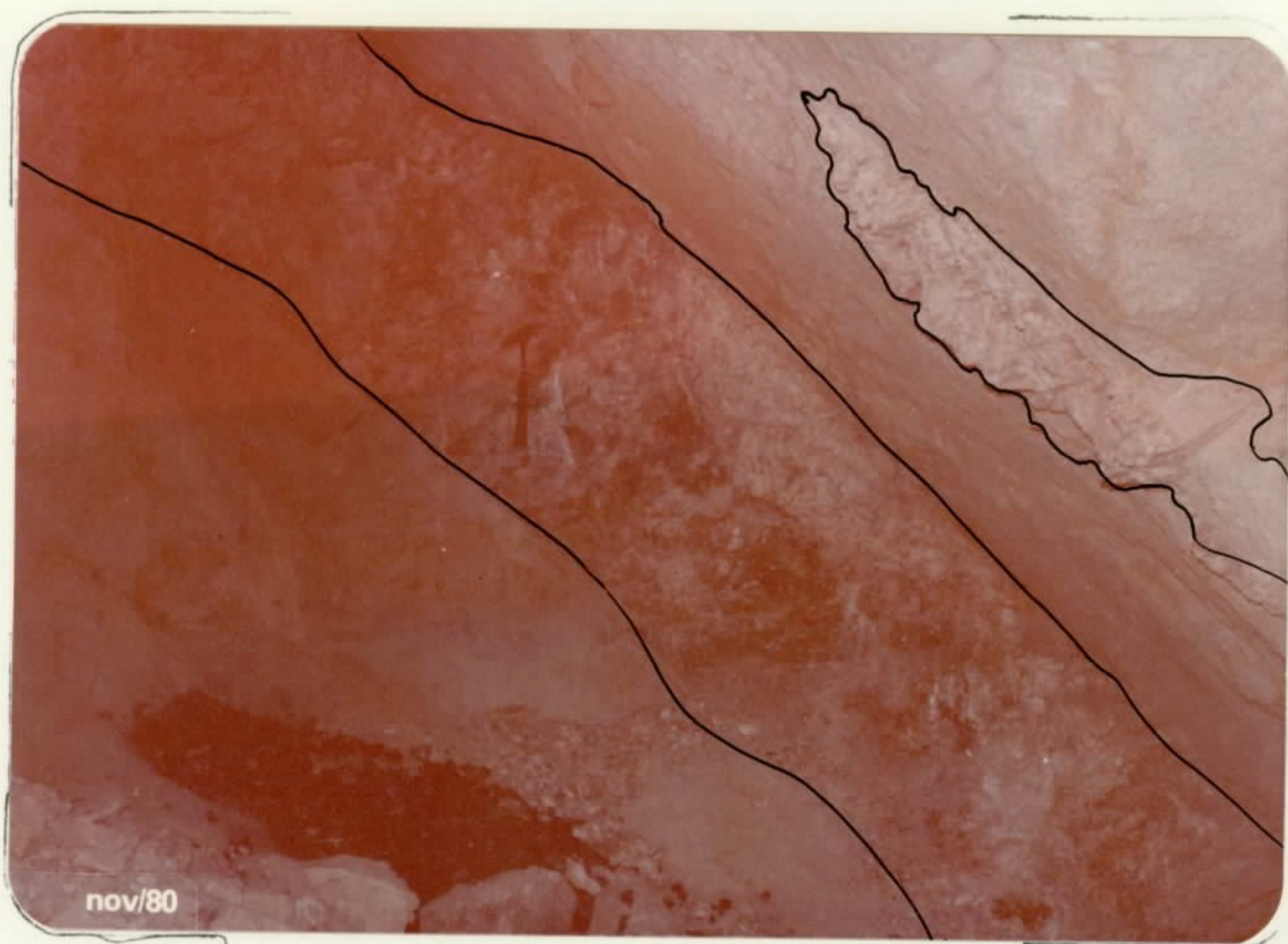
Foto nº 23 - Veeiro pegmatítico tabular encaixado em zona de fratura no biotita granito da Lavra do Frade. Nota-se na capa (parede do teto) res tos da parte já lavrada do veeiro. Local: Pedra do Frade - Coronel Murta (1033-GM-1)
