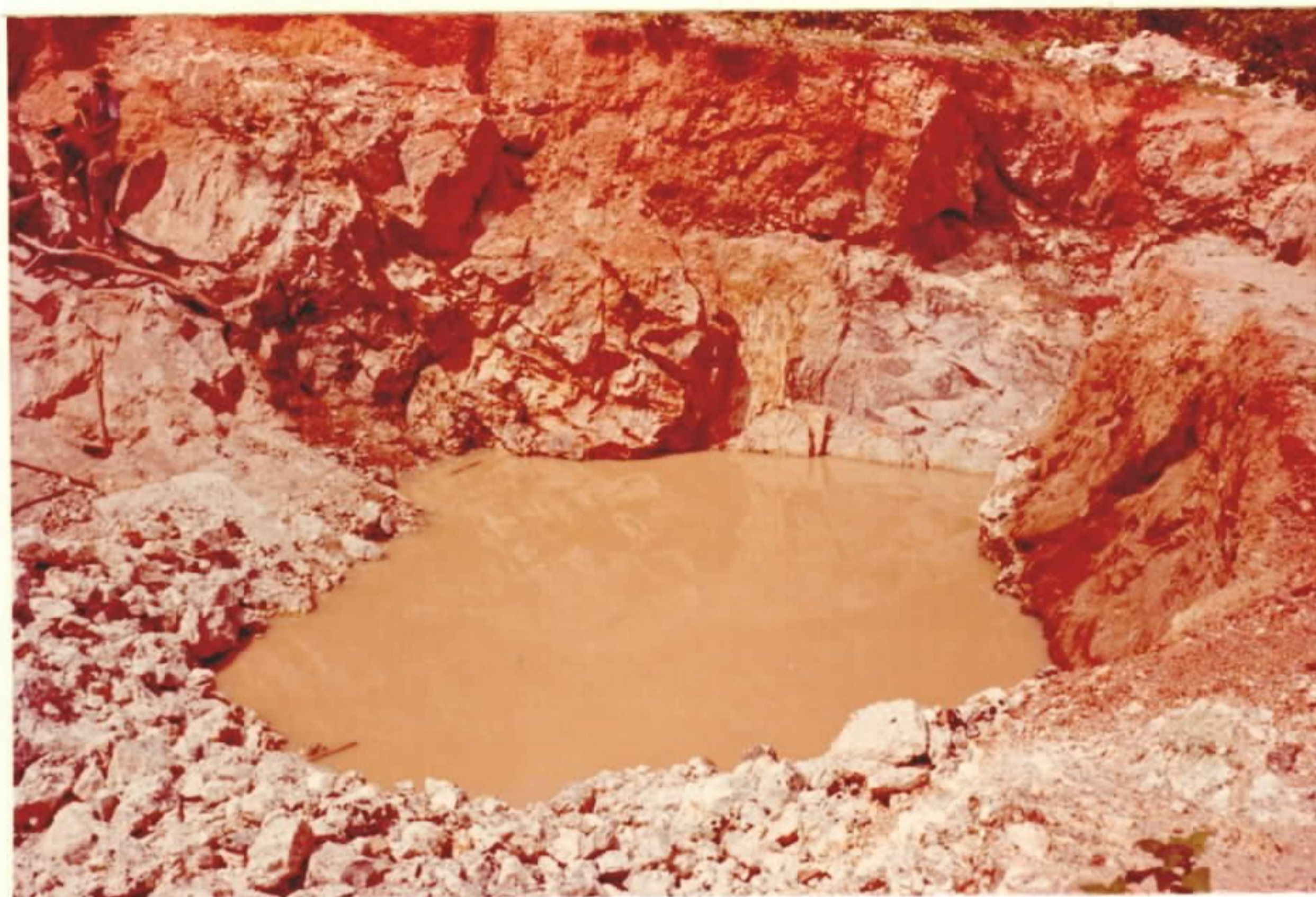
Foto 10 - Aspecto do garimpo; observa-se o contato do pegmatito com a encaixante no lado direito da foto. Berilândia I, mun. de Quixeramobim, Ceará.
