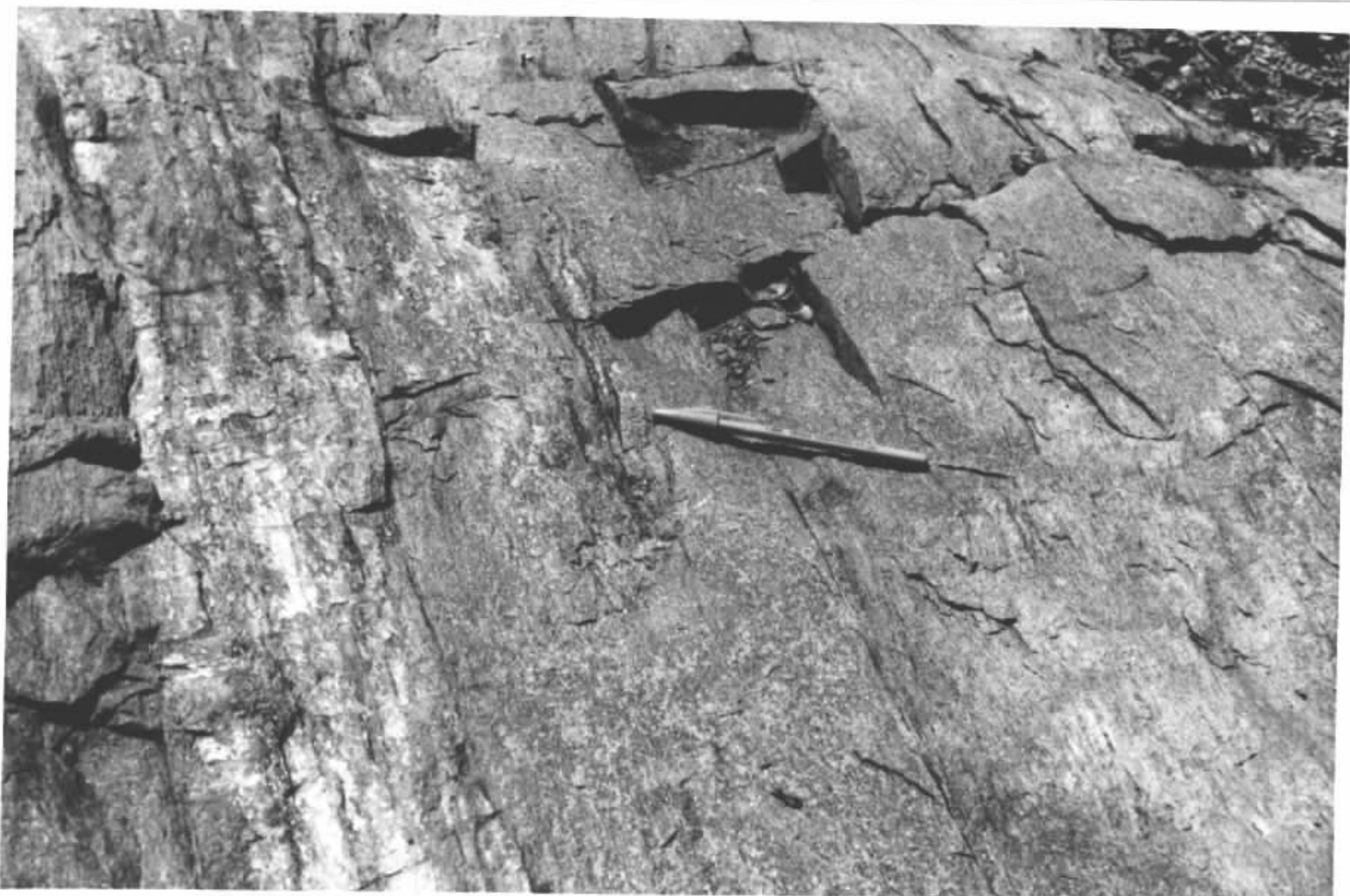
Foto 04 - Gnáisse róseo de granulação fina, bastante fraturado, tendo exibido radiação máxima de 250 c/s e 22 ppm de U_3O_8 , constituindo-se na anomalia AN-84-AG. O afloramento encontra-se relacionado a Falha de Jordão.
