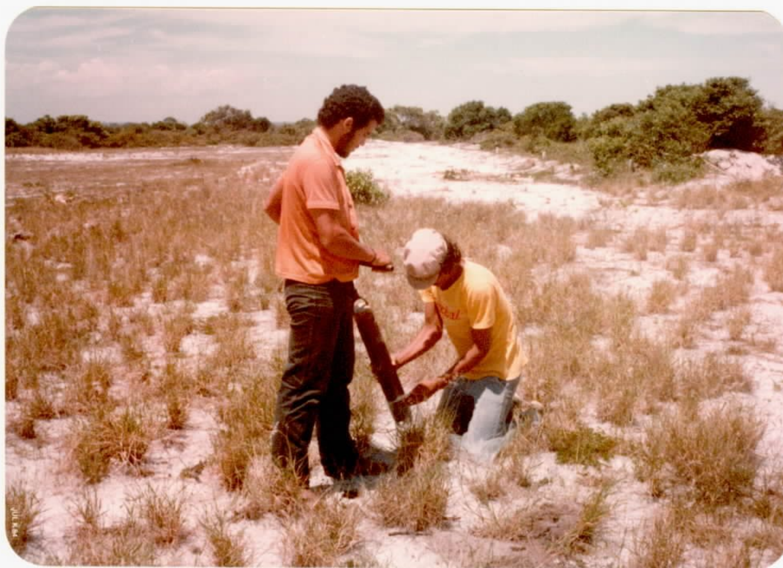
Foto nº 2 - Equipamento utilizado na prospecção aluvionar (trado adaptado). Aspecto da amostragem, nos cordões arenosos mais afastados da praia (Praia de Morobá - folha 13/14).
